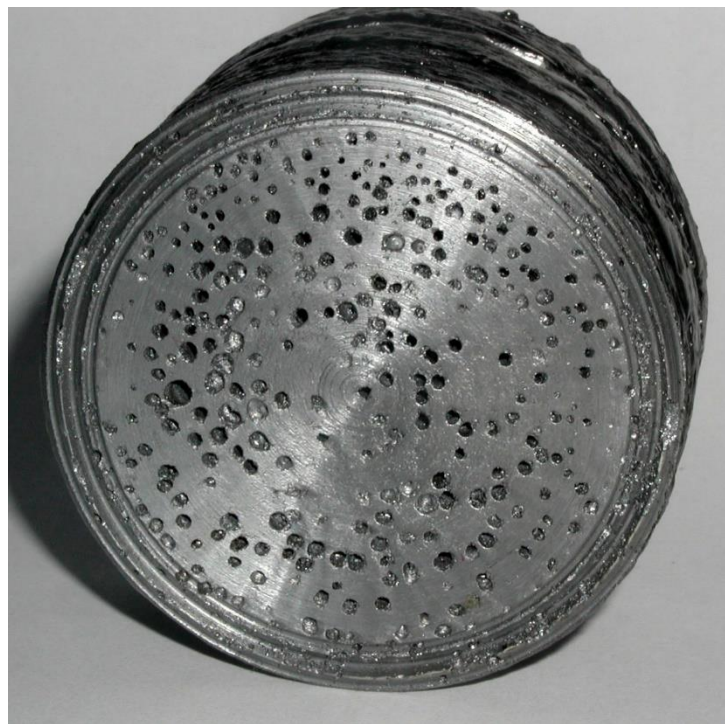
Рис. 3.11. Вид поперечного перерізу злитка ІТП, виплавленого із небрикетованої стружки.
