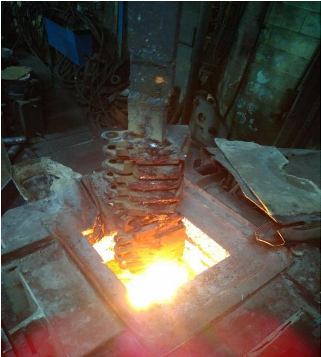
Рис. 5.4. Плавка в тигельній печі витратного електроду з кускових відходів.
