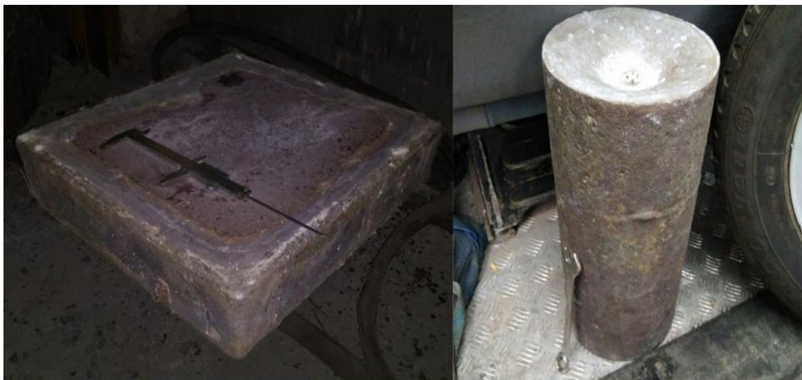
Рис. 5.5. Зовнішній вигляд плоскої заготовки та злитка отриманих з нержавіючої сталі.
