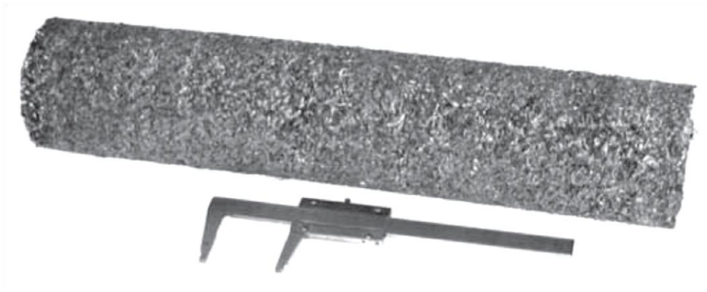
Рис. 3.1. Вид заготовки діаметром 100 мм, скомпактованої електротермічним способом із стружки.
