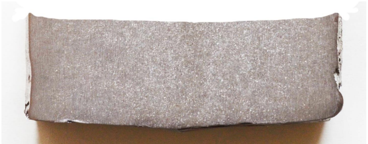
Рис. 5.6. Макроструктура плити з металу, отриманого електрошлаковою тигельною плавкою відходів сталі 12Х18Н10Т.
