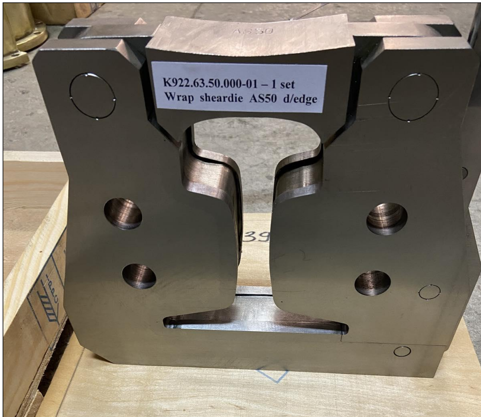
Рис. 5.7. Ніж для зняття ґрата (ґратознімач).
