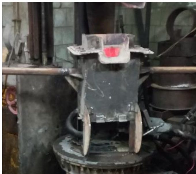
Рис. 3.9. Зовнішній вигляд тигельної печі для проведення досліджень.
