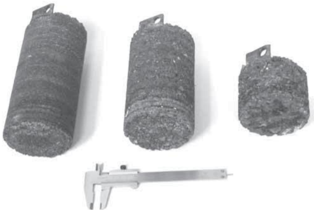
Рис. 3.2. Вид брикетів, скомпактованих електротермічним способом зі стружки.
