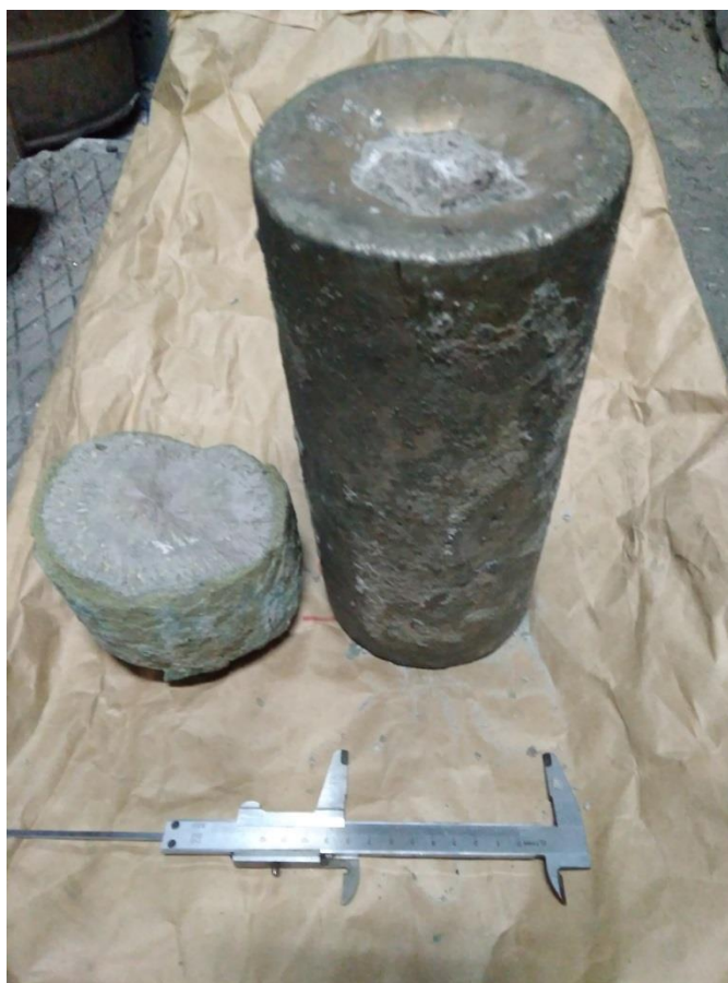
Рис. 5.2. Зовнішній вигляд злитка, виплавленого зі стружки жароміцного сплаву, і шлакової шапки.
