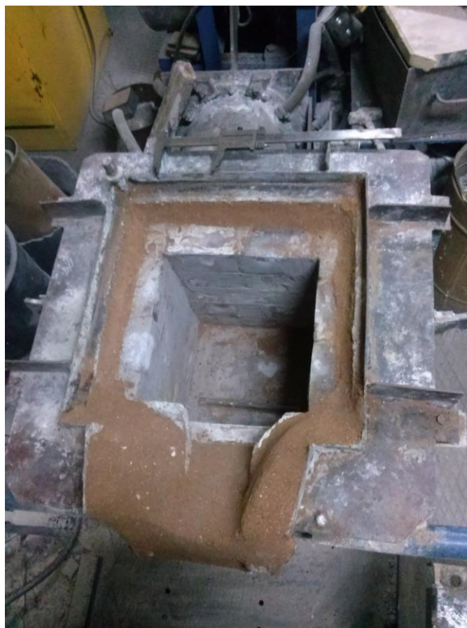
Рис. 2.5. Зовнішній вигляд плавильної ємності, футерованої периклазовою цеглою.
