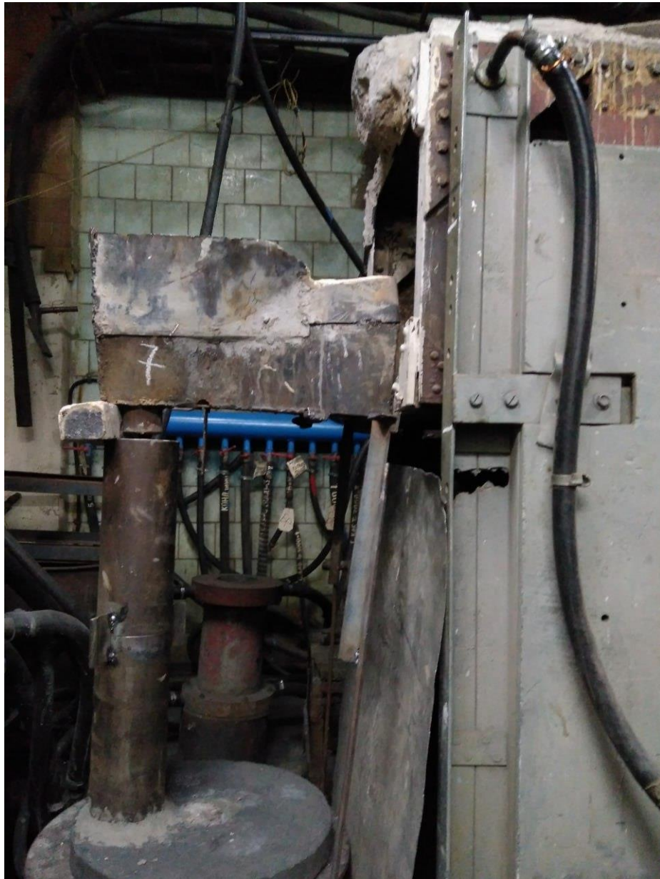
Рис. 2.6. Зовнішній вигляд індукційної установки з розливним пристроєм для плавки металевої стружки та отримання витратних електродів.
