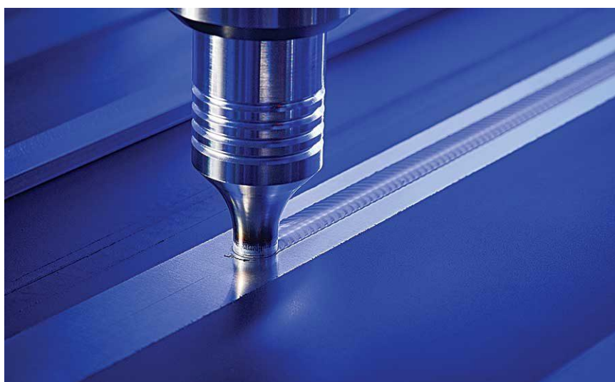
Рис.2.2. Робочий інструмент при ЗТП стикового з'єднання
