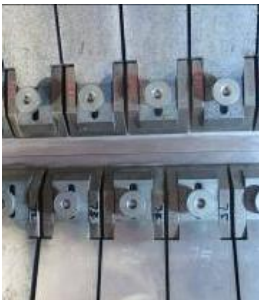
Рис. 2.3. Оснащення для притискання елементів з'єднання при ЗТП (вид зверху)
