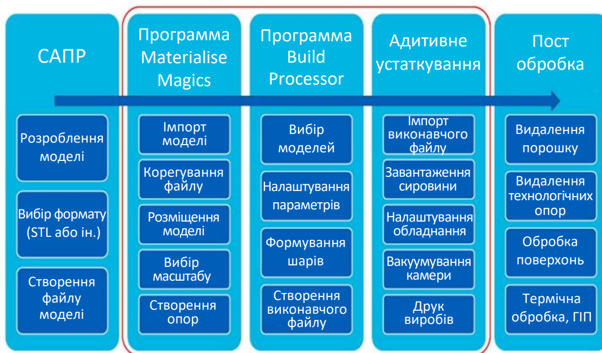
Рисунок 4.5. Етапи адитивного електронно-променевого виробництва
