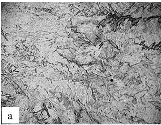
Рисунок 3.7. Мікроструктура наплавлення у верхній частині виробу: зразки а – (x100), б – (x200)
