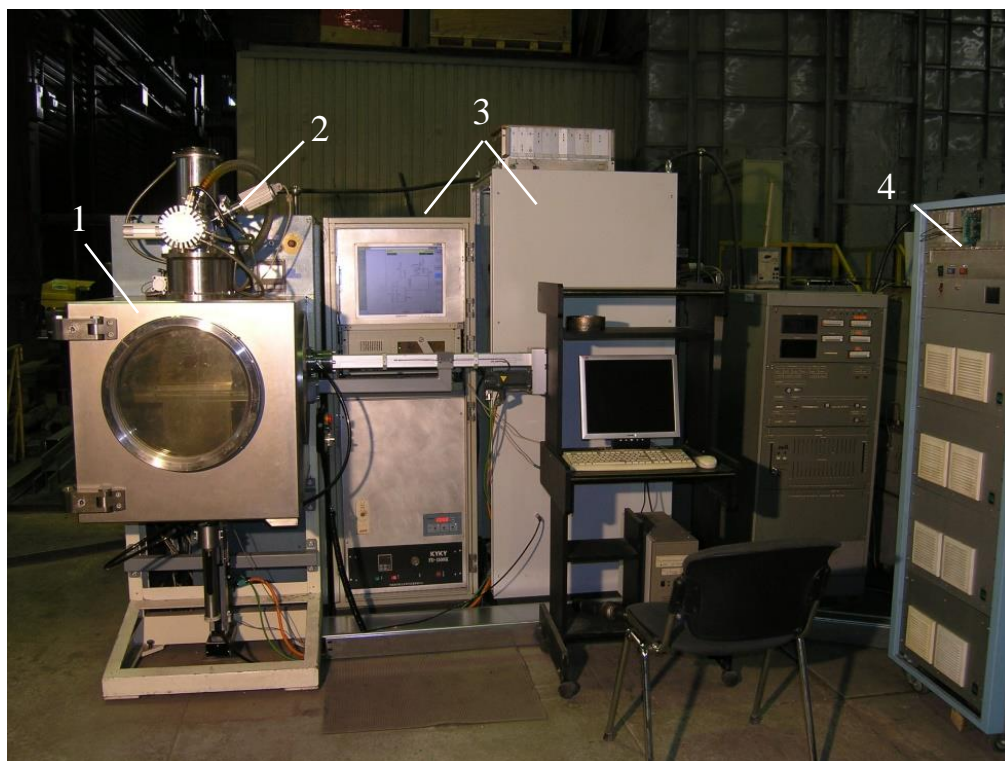
Рисунок 4.6. Експериментальна установка для електронно-променевого 3Д друку: 1 – вакуумна камера; 2 – електронно-променева гармата; 3 – шафи управління; 4 – високовольтне джерело
