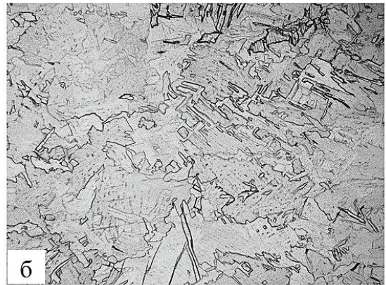
Рисунок 3.6. Структура наплавленого металу біля лінії сплавлення з підкладкою: а, б - зразки (x100)
