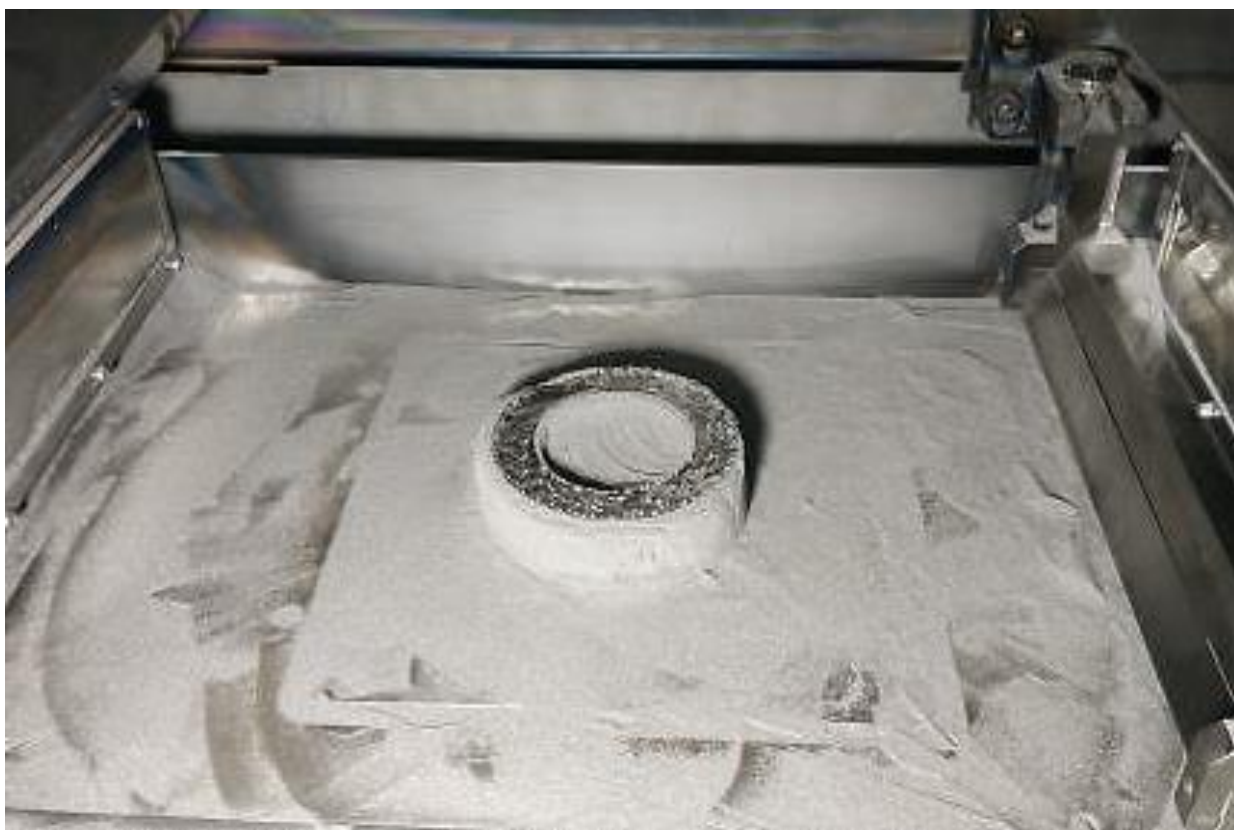
Рисунок 3.12. Виріб у вакуумній камері 3D принтера
