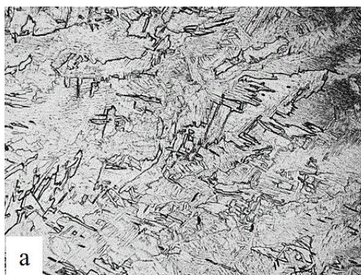
Рисунок 3.8. Структура металу зовнішніх шарів наплавлення: а, б – зразки (x100)
