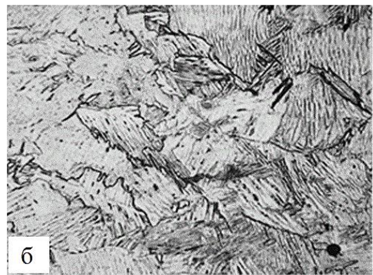
Рисунок 3.7. Мікроструктура наплавлення у верхній частині виробу: зразки а – (x100), б – (x200)
