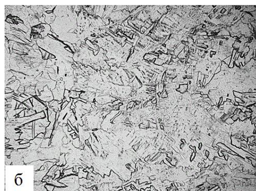
Рисунок 3.8. Структура металу зовнішніх шарів наплавлення: а, б – зразки (x100)
