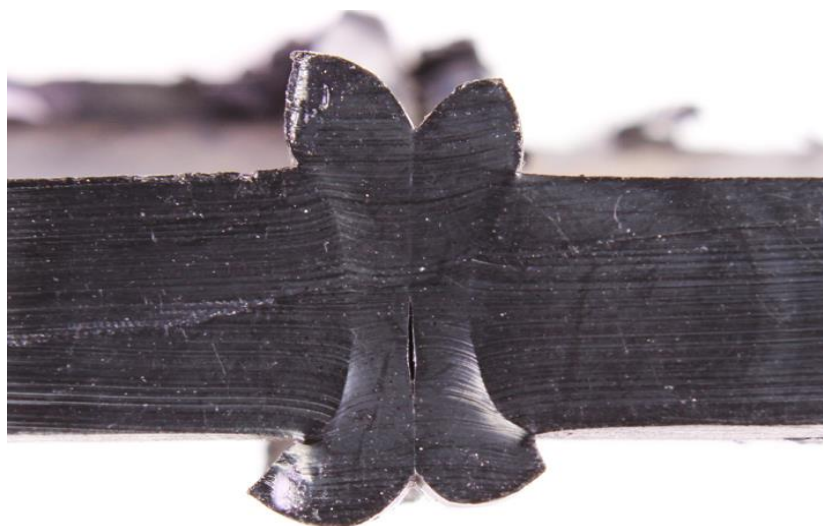
Рисунок 3.16 – Приклад традиційного непровару по лінії розділення в площині зварювання при недостатньому прогріві
