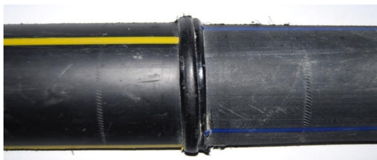
Рисунок 1.3 – Дефектне зварне з'єднання труб із поліетиленів технічних марок ПЕ-80 та ПЕ-63
