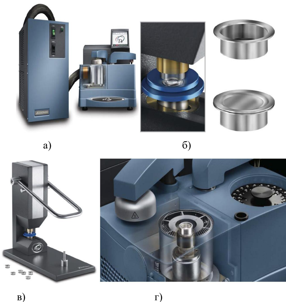
Рисунок 2.5 – Диференціальний сканувальний калориметр DSC Q2000 (а), алюмінієва кювета (б) та її підготовка до вимірювань (в), вимірювальна комірка приладу DSC Q2000 (г).
