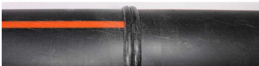
Рисунок 5.2 – Стикові зварні з'єднання труб із однотипних поліетиленів ПЕ-63 (а), ПЕ-80 (б) та ПЕ-100 (в)
