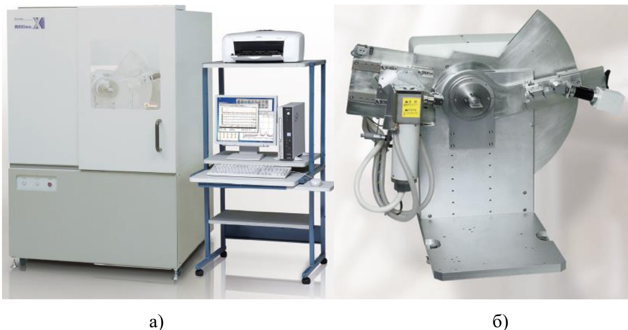
Рисунок 2.2 – Рентгенівський дифрактометр ShimadzuXRD-7000 (а) та його робоча вимірювальна комірка (б)
