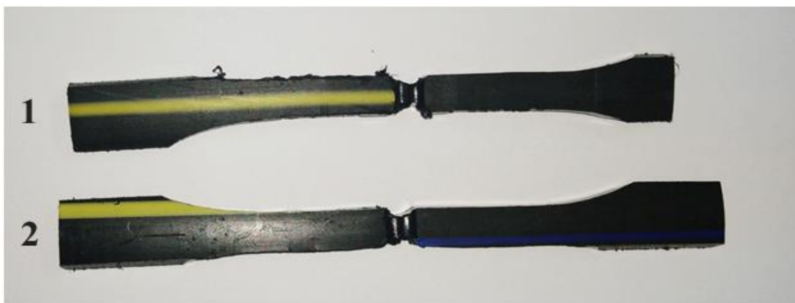
Рисунок 5.8 – Зразки-лопатки «із звуженою частиною у зварному з'єднанні»
