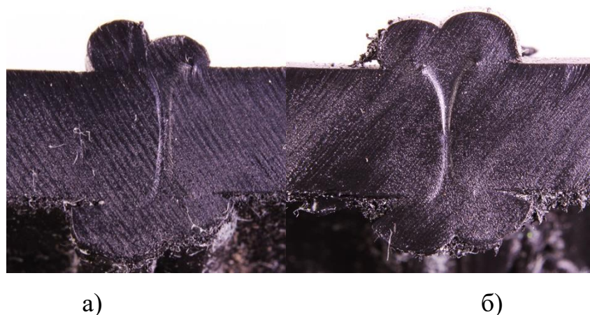
Рисунок 5.6 – Поперечний переріз стику труб із різнотипних поліетиленів, зварених за різними технологіями: а) за традиційною технологією; б) за новою технологією.
