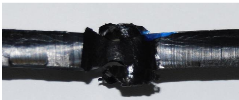
Рисунок 5.9 – Характер руйнування звуженого зразка-лопатки при випробуваннях на одновісний розтяг
