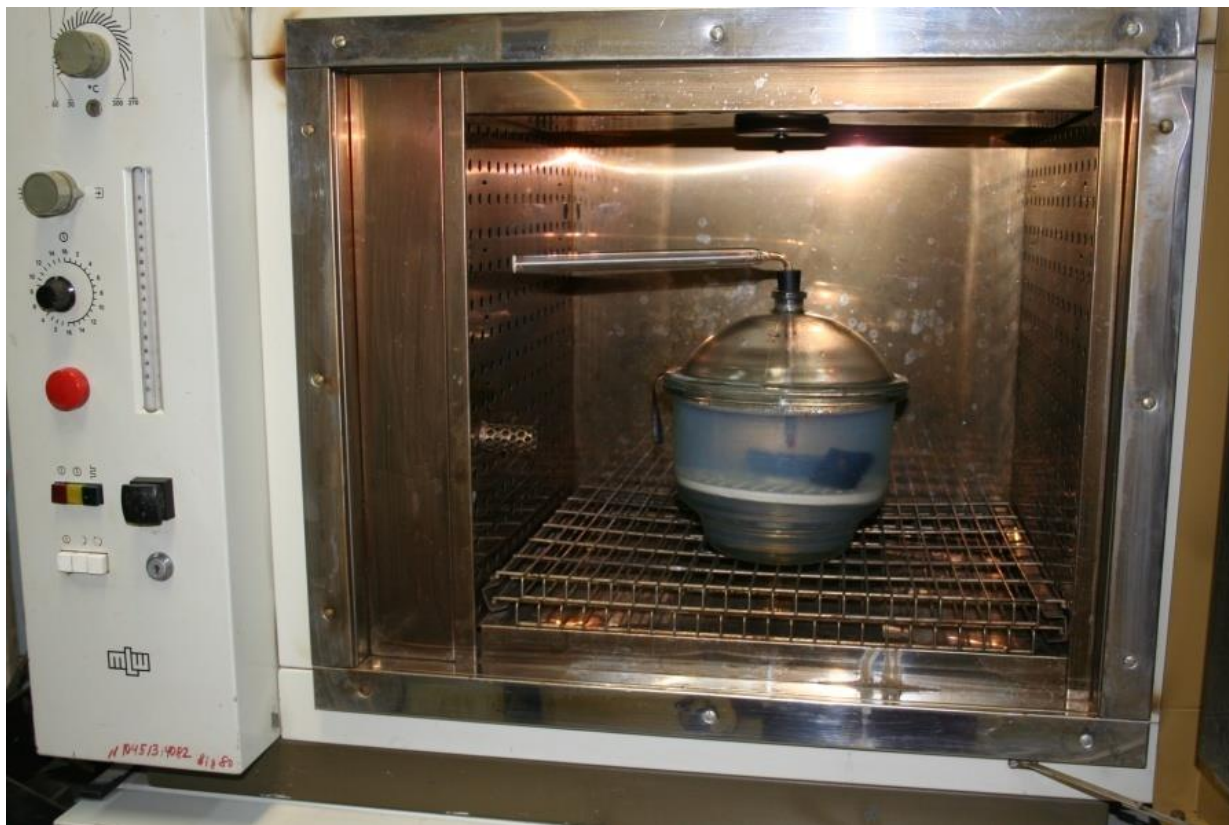
Рисунок 3.30 – Проведення випробувань ЗСЗ при постійній деформації у ємності з ААС при температурі 95 °С
