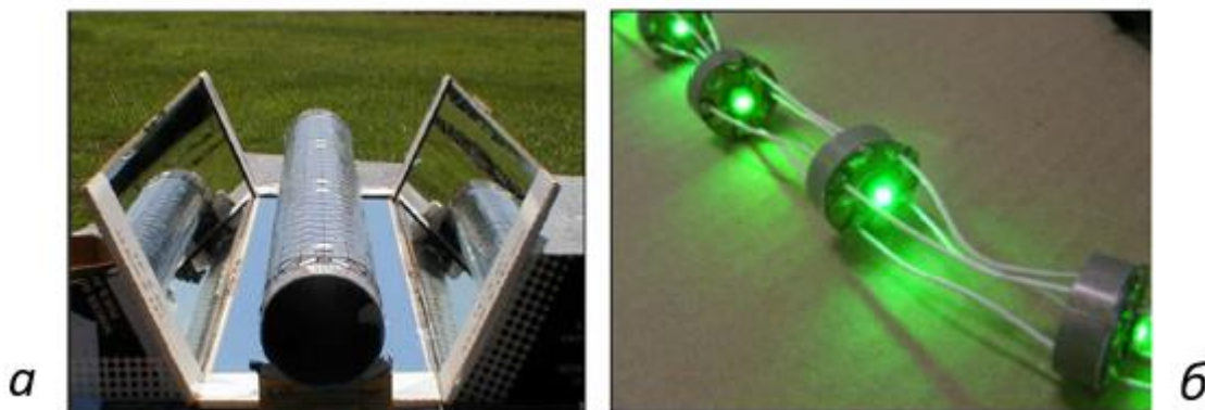
Рис. 1.13 Затвердіння смол УФ-випромінюванням з використанням сонячного випромінювання (а) [55] та ламп для затвердіння (б) [57].
