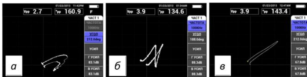
Рис. 3.27 Відображення дефектів в імпедансній площині; а-пора; б-тріщина; в- напусткове сходження швів.
