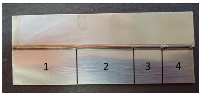
Рис.3.23 Тестовий (налаштувальний) зразок зварного шва гладкої конічної заготовки секції КПО з товщиною \delta=0,3 мм з фрагментами (1)-(4), що імітують перехідні режими зварювального процесу
