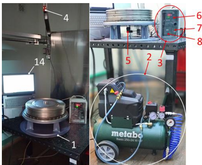
Рис.3.30 Основні частини експериментального стану розкриття 11 секційної КПО
