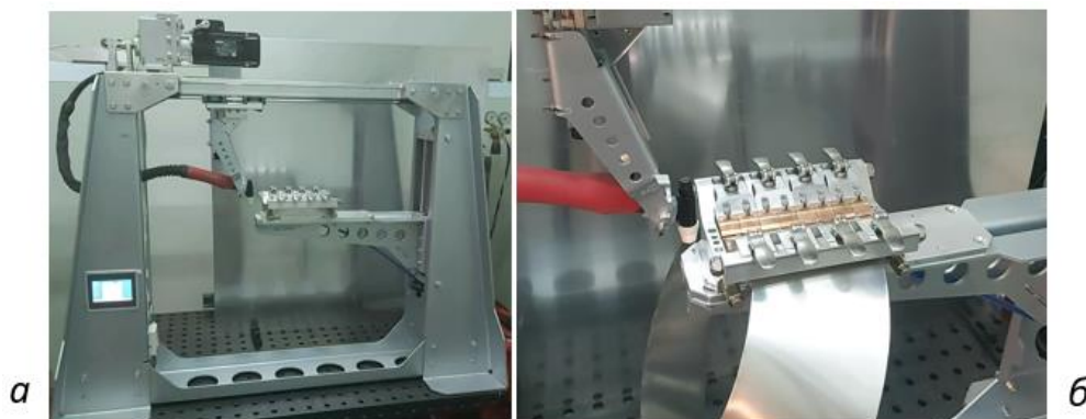
Рис. 3.2 Загальний вид установки для зварювання прямолінійних швів (а) та пристрій для збирання та захисту прямолінійних швів секцій КПО при зварюванні (б)
