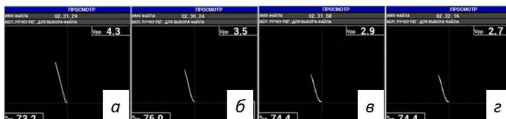
Рис.3.24 Результати фіксації максимальної амплітуди та кута сигналу на тестовому (налаштовувальному) зразку зварного шва (за Рис.3.23)
