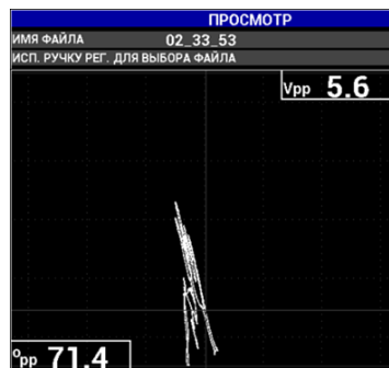
Рис.3.25. Результат фіксації параметрів сигналу в імпедансній площині при поздовжньому скануванні зразка за Рис.3.23
