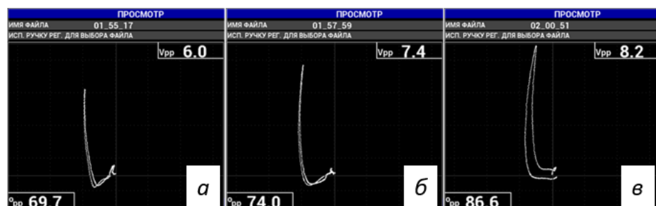
Рис.3.22 Сигнали рисок EDM глибиною 0,5 мм (а), 1,0 мм (б) та 2,0 мм (в) при калібруванні дефектоскопа на сертифікованому зразку зі сталі AISI 321
