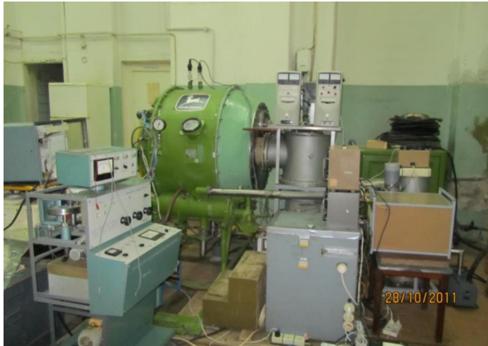
Рисунок 1.9. - Загальний вигляд установки для відпрацювання електронно-променевого зварювання в умовах високого вакууму.
