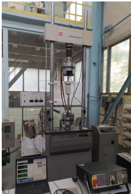
Рис. 4.18 – Універсальний сервогідролічний випробувальний комплекс MTS 318.25 (США, Material Test System) обладнаний кріостатом для проведення випробувань на одновісний розтяг зразків за пониженої температури -180\text{ }^{\circ}\text{C} \pm 5^{\circ}\text{C} згідно ДСТУ 7305:2013
