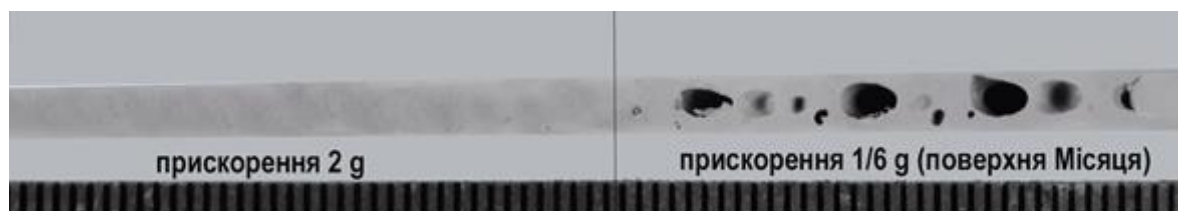
Рисунок 2.3 – Макрошліф поверхневого зрізу зразка стикового з'єднання зі сплаву 5456, одержаного за один прохід електронно-променевим зварюванням на літаючій лабораторії в режимі перевантаження з прискоренням 2g і в режимі зниженого прискорення 1/6g (поверхня Місяця) [6]
