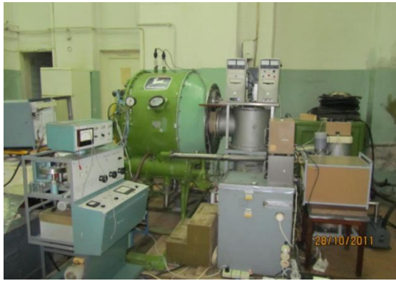
Рис.1.3. Обладнання для проведення наземного експерименту з ручного електронно-променевого зварювання та різання:
