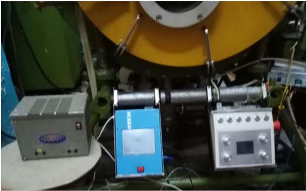
Рисунок 4.1 – Блок розгортки на експериментальній установці: зліва – підсилювач з блоком живлення, в центрі – генератор розгортки з мікроконтролером PIC18F87J50 та кольоровим графічним дисплеєм 5,7”
