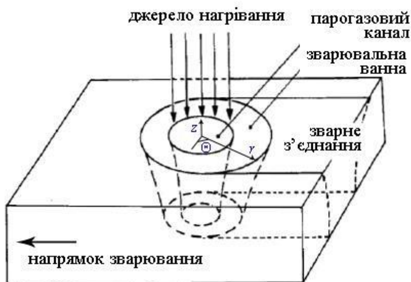
Рисунок 2.1-Умовна схема зварювання зі стаціонарним парогазовим каналом [100]
