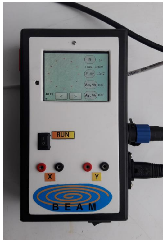
Рисунок 4.2 – Генератор розгортки (переносний варіант) з мікроконтролером PIC18F67K40 та кольоровим графічним дисплеєм 2,83”
