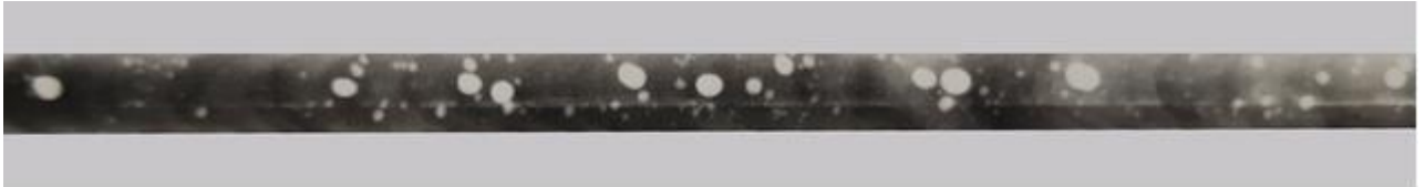
Рисунок .1.10 – Рентгенограма стикового з'єднання сплаву АМг6, одержаного електронно-променевим зварюванням на літаючій лабораторії в режимі зниженої гравітації 1/6g (поверхня Місяця)
