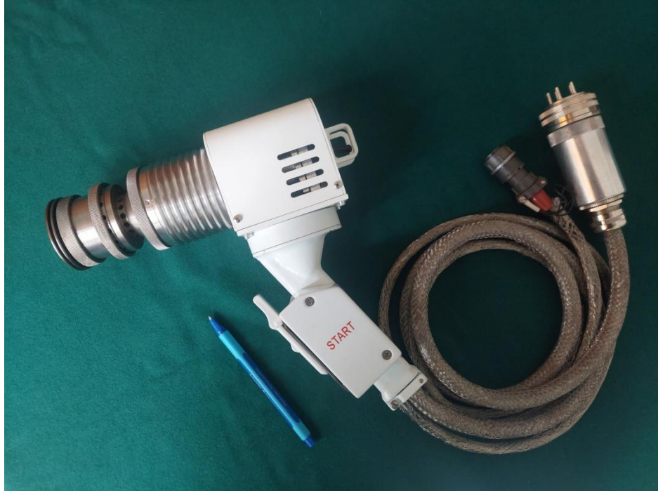
Рисунок 3.18 Загальний вигляд розробленого ручного електронно-променевого інструменту [131]
