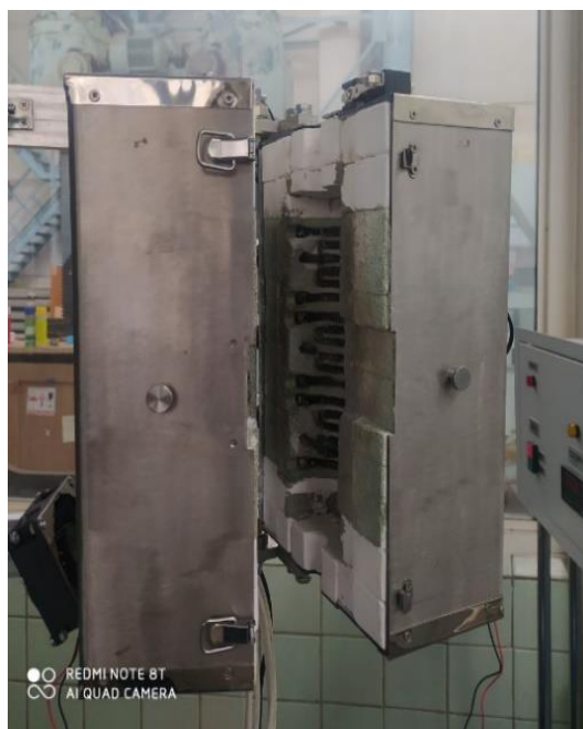
Рис. 4.17 – Високотемпературна система нагріву SEO 001/12/18 зразків для випробувань на одновісний розтяг за підвищеної температури
