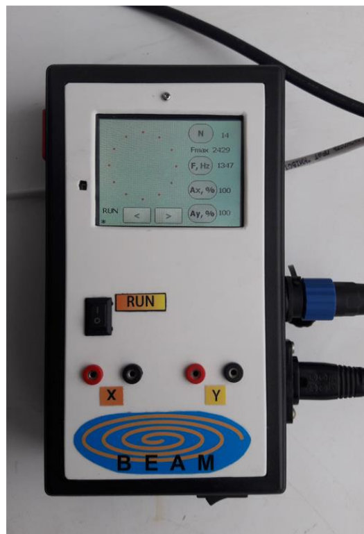
Рис. 4.2 – Генератор розгорток (переносний варіант) з мікроконтролером PIC18F67K40 та кольоровим графічним дисплеєм 2,83”
