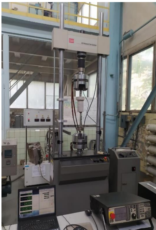
Рис. 4.18 – Універсальний сервогідролічний випробувальний комплекс MTS 318.25 (США, Material Test System) обладнаний криостатом для проведення випробувань на одновісний розтяг зразків за пониженої температури -180\text{ }^{\circ}\text{C} \pm 5\text{ }^{\circ}\text{C} згідно ДСТУ 7305:2013
