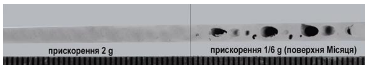
Рис. 2.3 – Макрошліф поверхневого зрізу зразка стикового з'єднання зі сплаву 5456, одержаного за один прохід електронно-променевим зварюванням на літаючій лабораторії в режимі перевантаження з прискоренням 2g і в режимі зниженого прискорення 1/6g (поверхня Місяця) [6]
