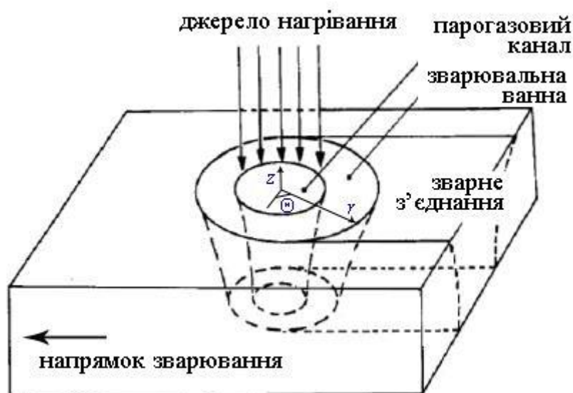
Рис. 2.1 -Умовна схема зварювання зі стаціонарним парогазовим каналом [100]
