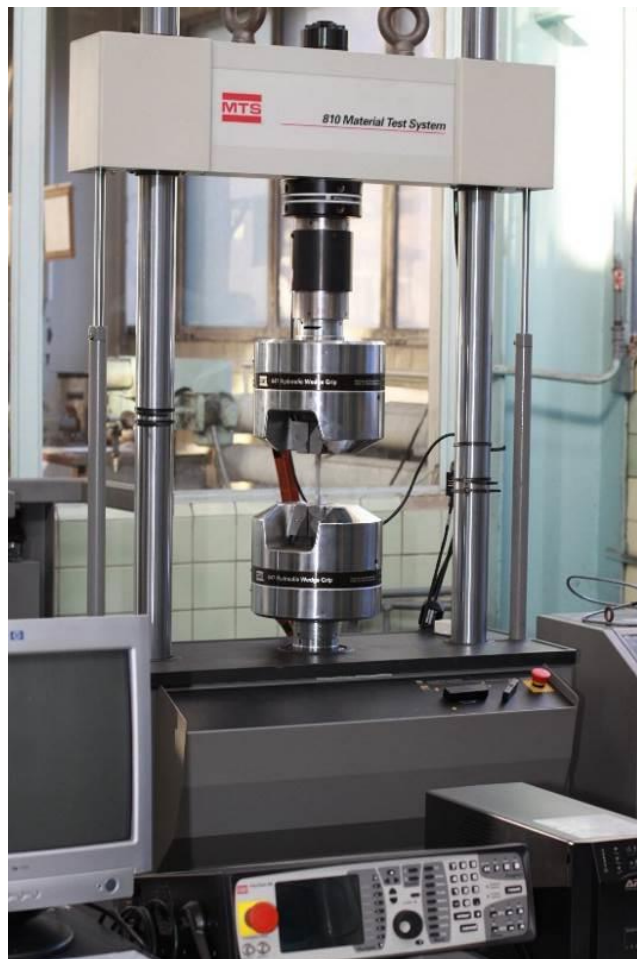
Рис. 1.14 – Універсальний сервогідравлічний випробувальний комплекс MTS 318.25 (США, Material Test System)
