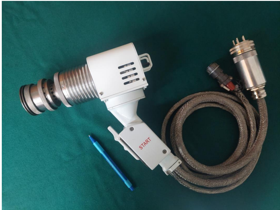
Рис. 3.18 Загальний вигляд розробленого ручного електронно-променевого інструменту [131]
