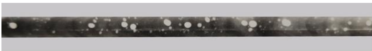
Рис. 1.10 – Рентгенограма стикового з'єднання сплаву АМгб, одержаного електронно-променевим зварюванням на літаючій лабораторії в режимі зниженої гравітації 1/6g (поверхня Місяця)
