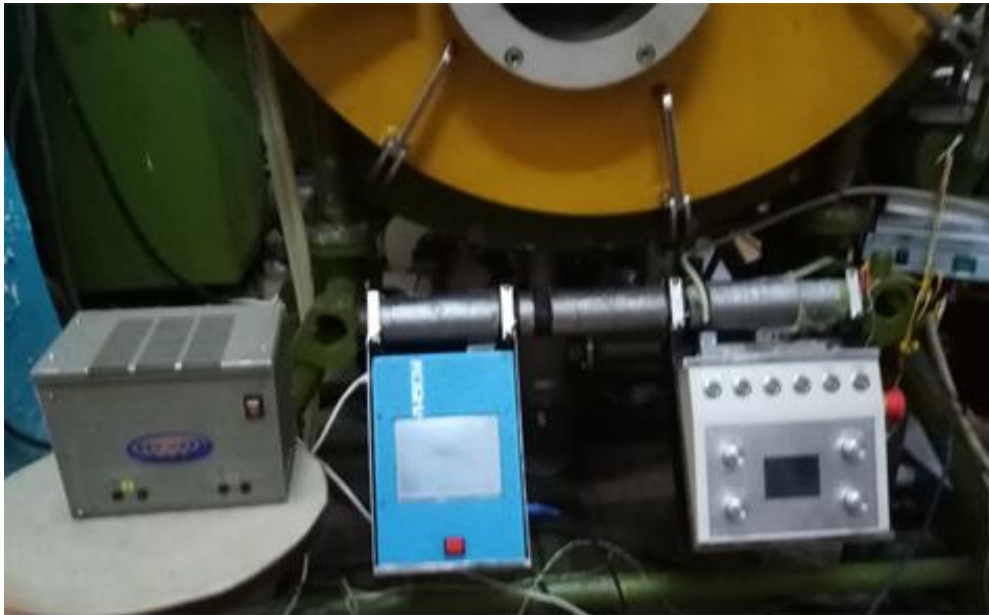
Рис. 4.1 – Блок розгорток на експериментальній установці: зліва – підсилювач з блоком живлення, в центрі – генератор розгорток з мікроконтролером PIC18F87J50 та кольоровим графічним дисплеєм 5,7”
