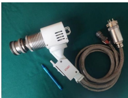
Рисунок 6 – Загальний вигляд розробленого ручного електронно-променевого інструменту
