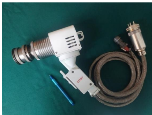
Рисунок 6 – Загальний вигляд розробленого ручного електронно-променевого інструменту
