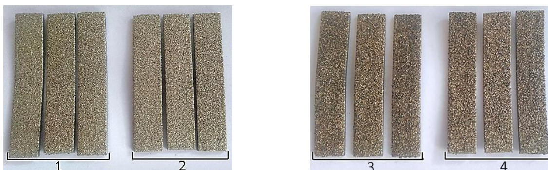
Рисунок 4.7 – Зразки з Zr-покриттям після випробувань на статичне трьохточкове згинання: 1; 3 – в зоні стиску та 2; 4 – в зоні розтягу
