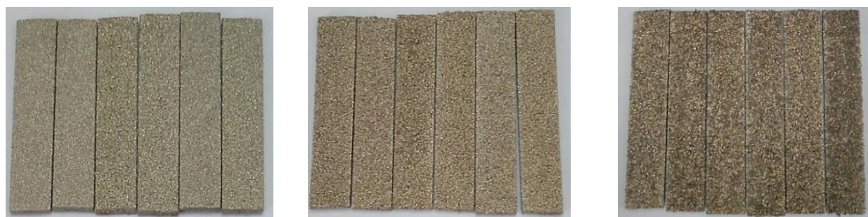
Рисунок 4.6 – Зразки із МПН Zr-покриттям різної об'ємної пористості для випробувань на статичне трьохточкове згинання
