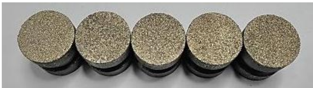
Рисунок 4.10 – Зовнішній вигляд напилених Zr-покриттів на поверхнях циліндричних зразків із титанового сплаву марки ВТ6
