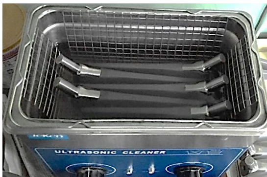
Рисунок 5.4 – Ультразвукове очищення деталей ендопротезів у ванні Ultrasonic cleaner PS - 40
