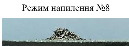
Рисунок 3.12 – Профілі фігур металізації із Zr-дроту отримані на режимах МПН згідно з табл. 3.2 (а); криві що описують їх профіль по плямі наплення: — експериментальний, - - графік нормального розподілу Гауса (б) та його функція (в)
