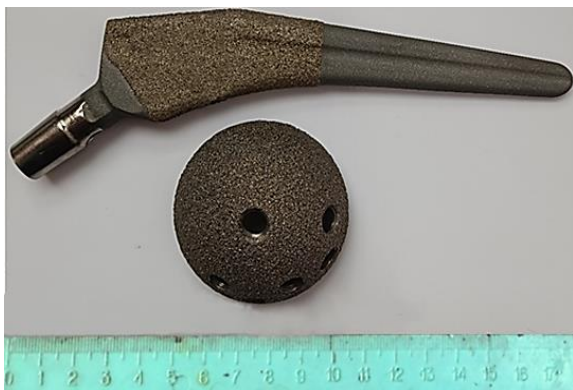
Рисунок 13 – Біосумісні Zr-покриття на деталях ендопротеза кульшового суглоба
