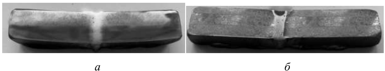
Рисунок 6.40 - Макрошліфи зварного з'єднання економнолегованого титанового псевдо- \beta -сплаву LCB-5.1, виконаного ЕПЗ: a – в стані після зварювання з попереднім підігрівом 400°С режим №3 (табл. 6.13); б –сплав LCB-5.1 в стані після ЛТО режим №4 (табл. 6.13)
