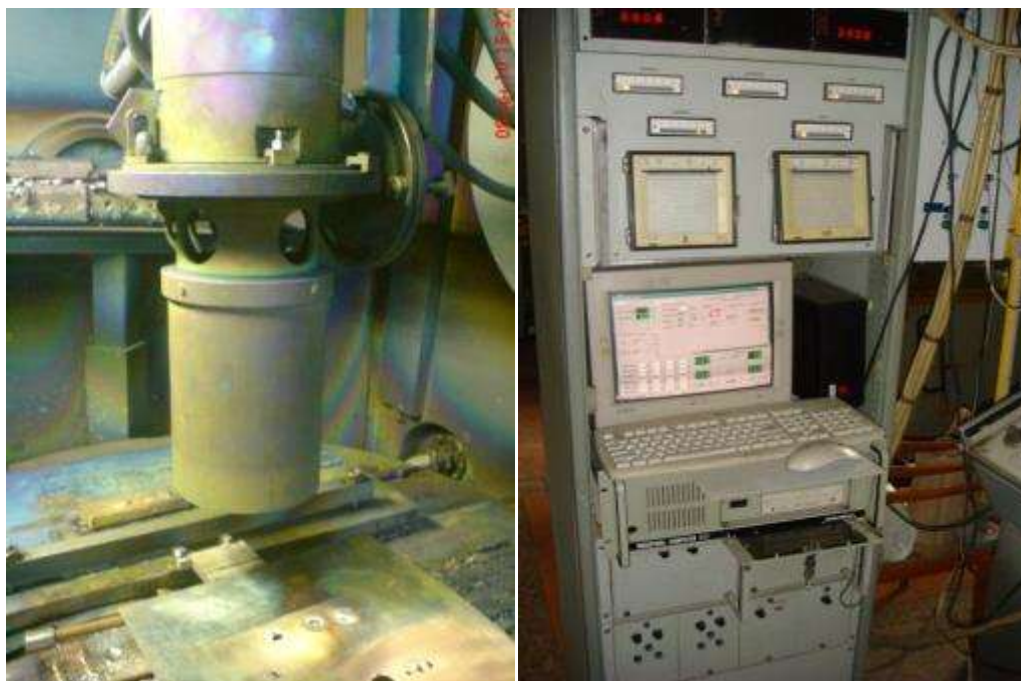
Рисунок 2.6 - Зовнішній вид електронно-променевої гармати ЦФ-19 та прилада керування променем СУ-220 установки УЛ-144
