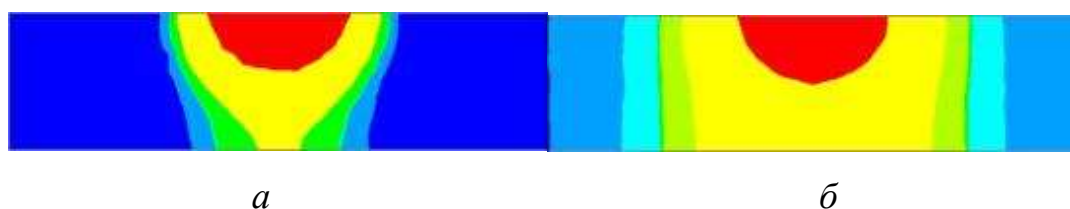
Рисунок 3.8 – Глибина і ширина металу шва і зони термічного впливу зварних з'єднань економнолегованого титанового сплаву, отриманих на різних режимах зварювання: а – режим №1, б – режим №2
