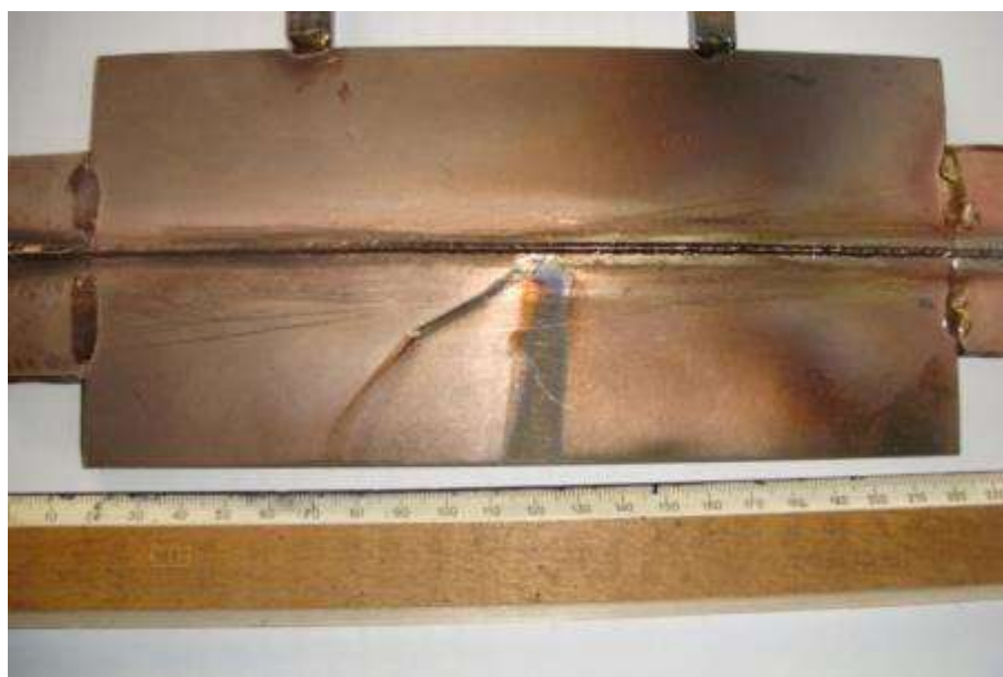
Рисунок 2.18 - Зварне з'єднання титанового псевдо- \beta -сплаву ВТ19, виконане ЕПЗ ( I_{л} = 120\text{mA} , V_{зв} = 7\text{мм/с} ) в стані після зварювання з попереднім підігрівом до 400°C, коренева сторона
