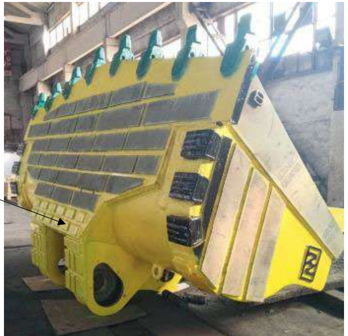
Рис. 5.20 Ківш навантажувача «Caterpillar» ємністю 15 м 3 , зміцнений зносостійкими листами і біметалевими армуючими елементами (світлого кольору)
