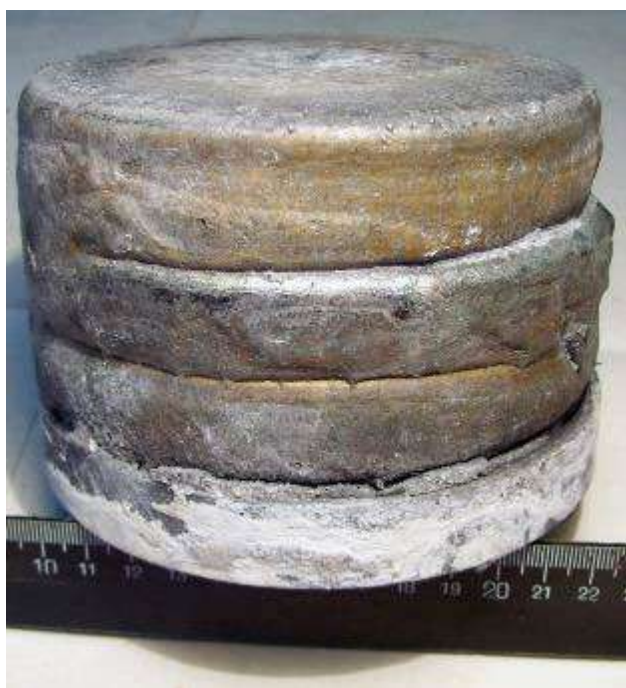
Рис. 5.6 Зовнішній вигляд бічної (а) і верхньої (б) поверхні багат шарового зливка \varnothing 180 мм
