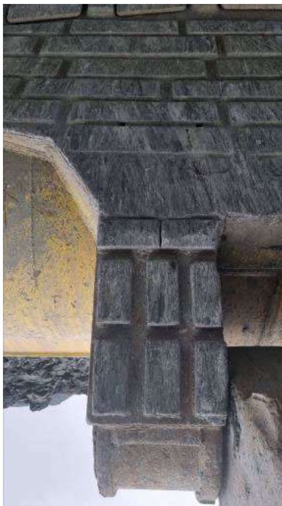
Рис. 5.22 Ліва сторона зношеної поверхні ковша
