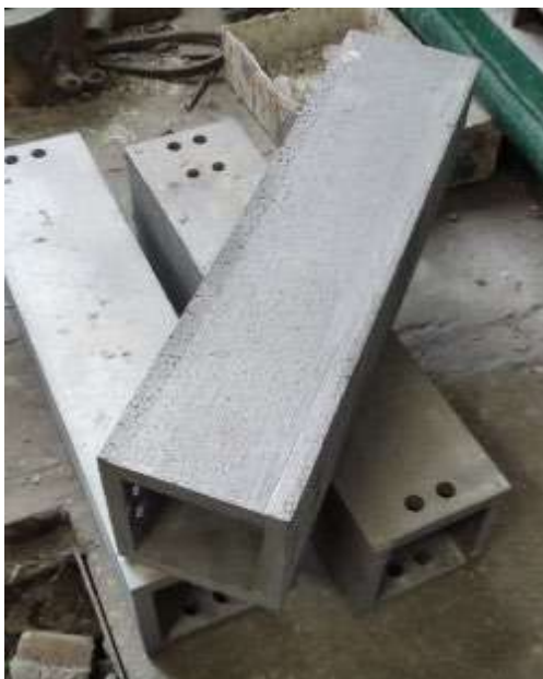
Рис. 5.17 Наплавні електроди квадратного перерізу 120x120 мм
