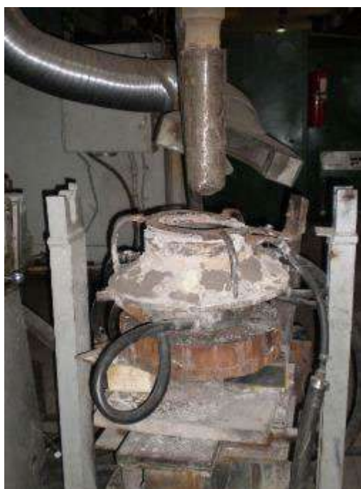
Рис. 5.2 Завершальний етап електрошлакового наплавлення із вилученням зі шлакової ванни електрода діаметром 90 мм.
