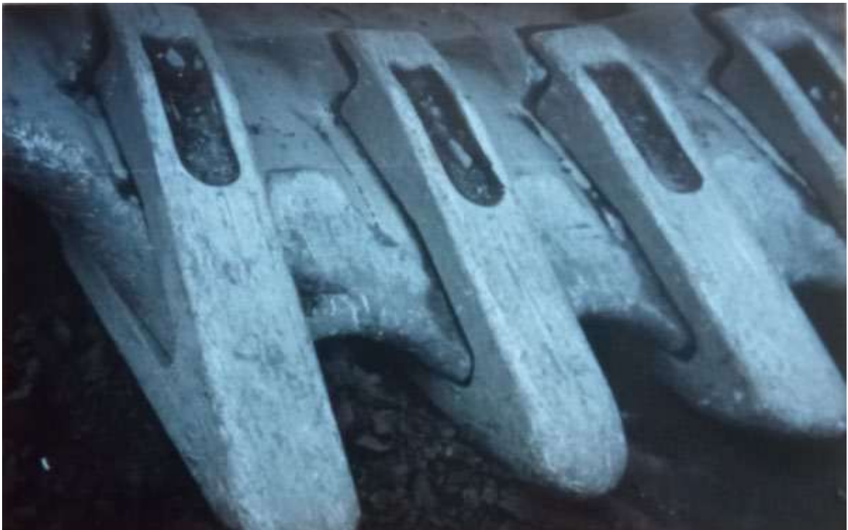
Рис. 5.15 Зношування передньої стінки ковша кар'єрного екскаватора ЕКГ-8 у проміжках між його зубами
