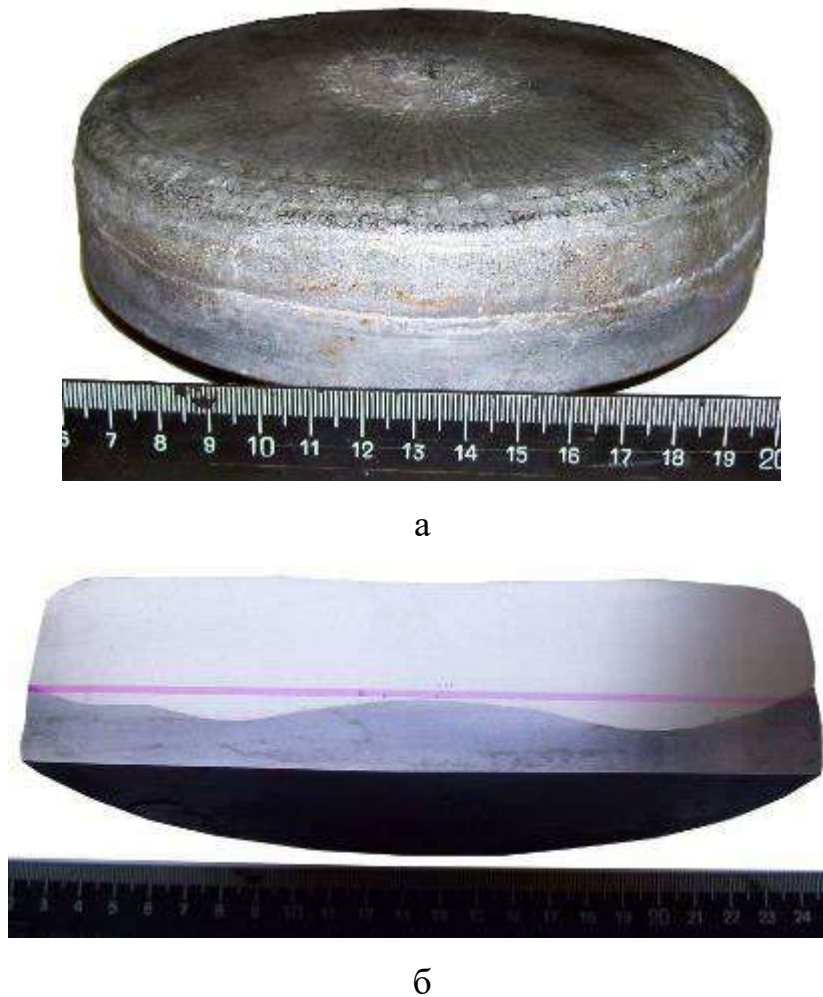
Рис. 5.3 Зовнішній вигляд напавленої заготовки \varnothing 180 мм (а) і проплавлення основного металу (б).
