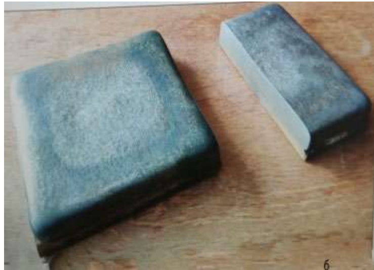
Рис. 5.19 Наплавлена заготівка (армуючий елемент) та її поперечний переріз
