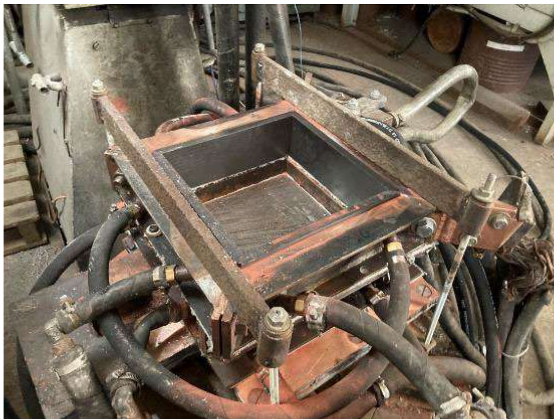
Рис. 5.16 Струмопідвідний кристалізатор з внутрішнім перерізом 200x200 мм
