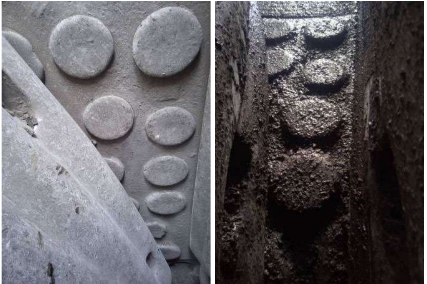
Рис. 5.12 Зовнішній вигляд наплавленої поверхні футеровки через: а – 4 місяці; б – 9 місяців
