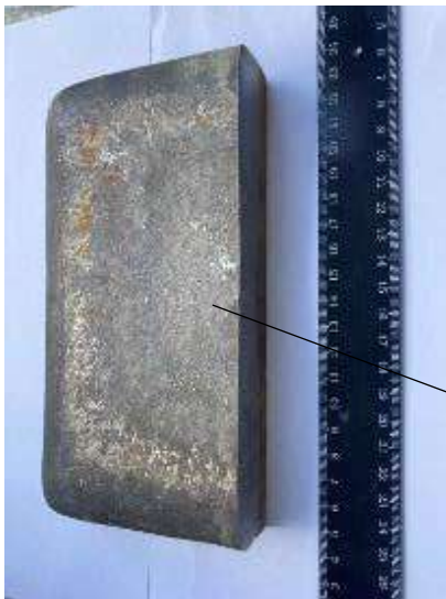
біметалева армуюча плитка виготовлена в СПК квадратного перетину
