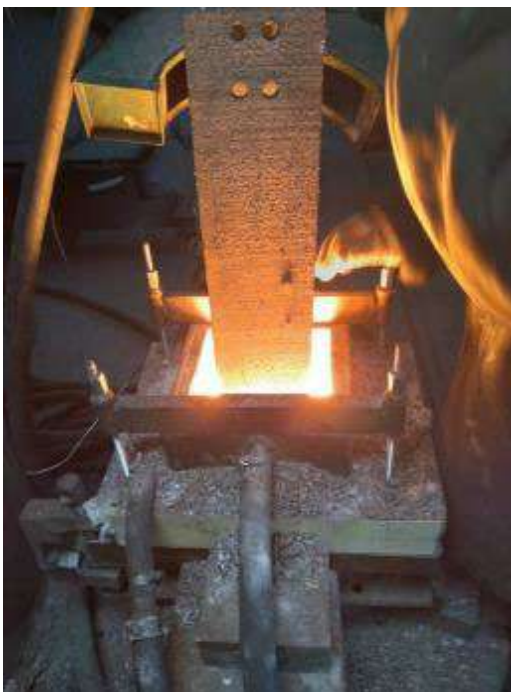
Рис. 5.18 Процес ЕШН у СПК квадратного перерізу
