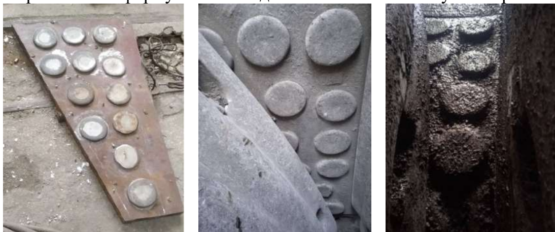
Рис. 11 – Зовнішній вигляд напавленої поверхні футеровки через: а – до експлуатації; б – 4 місяці; в – 9 місяців
