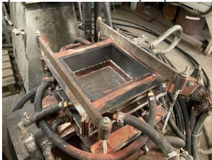
Рис. 10 – Струмopідвідний кристалізатор з внутрішнім перерізом 200x200 мм
