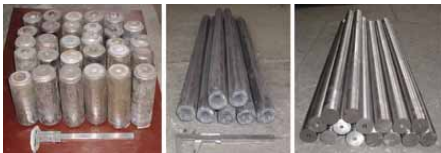
Рисунок 29 – Зливки прецизійного сплаву 29НК технології ЕШП та виготовлені з них поковки та прутки
