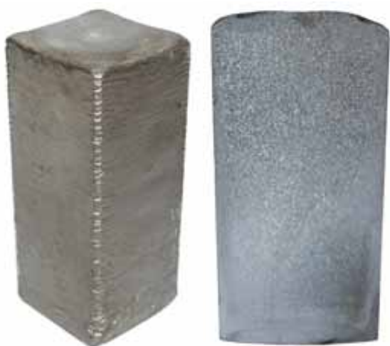
Рисунок 19 – Зовнішній вигляд і макроструктура титанового зливка \square 80 \times 80 мм, виплавленого з одночасними розрядами на соленоїд і металургійну ванну
