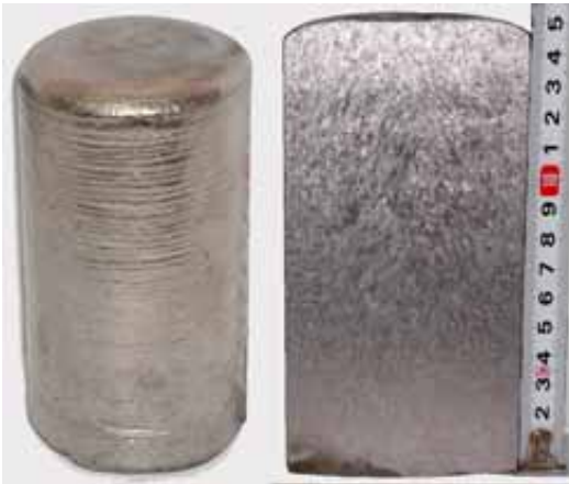
Рисунок 5 – Зовнішній вигляд і макроструктура титанового зливка виплавленого з періодичним зменшенням потужності: t_1 = 7 с, t_{\text{п}} = 1,4 с
