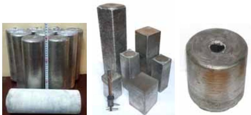
Рисунок 27 – Зливки титанових сплавів технології ЕШП, різного поперечного перерізу
