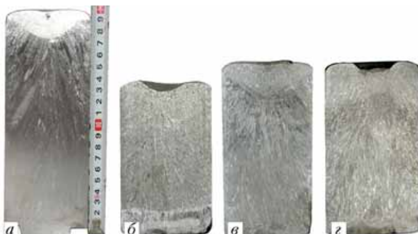
Рисунок 15 – Макроструктура титанових зливків \square 80 \times 80 мм, виплавлених з розрядами конденсаторів на ванну: a – f=3,0 Гц, I_{\text{розр}}=6,4 кА; б – f=1,0 Гц, I_{\text{розр}}=11,5 кА; в, з – f=0,9 Гц, I_{\text{розр}}=12,0 кА
