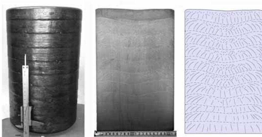
Рисунок 12 – Зовнішній вигляд, макроструктура і схема кристалізації зливка діаметром 220 мм, отриманого ЕШП з пошаровою кристалізацією
