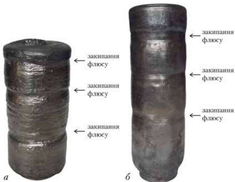
Рисунок 6.4 – Гофри на поверхні злитків ЕШП, спричинені закипанням флюсу та падінням струму плавки: а – флюс АНФ-1; б – флюс АНФ-6
