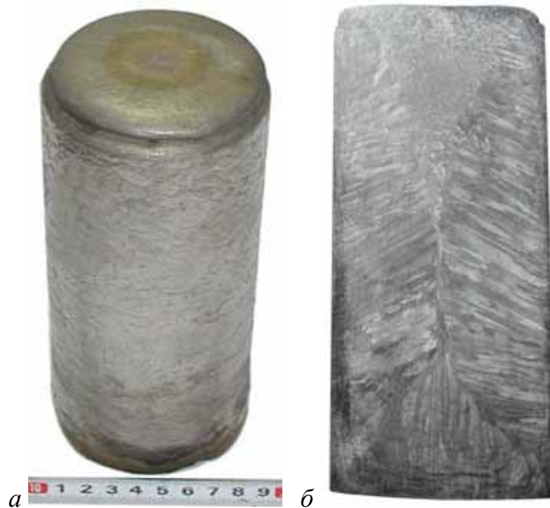
Рисунок 4.10 – Зовнішній вигляд (а) і макроструктура (б) зливка сплаву 29НК (плавка № 905), виплавленого без пошарового формування
