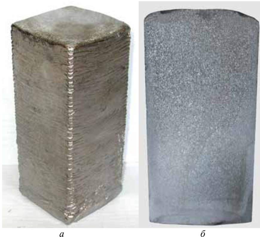
Рисунок 5.34 – Зовнішній вигляд (а) та макроструктура (б) титанового зливка № 894
