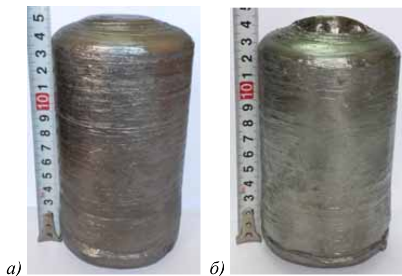
Рисунок 6.6 – Зливки титану ВТ1-0, виплавлені при тиску 25 кПа (а) і 160 кПа (б)
