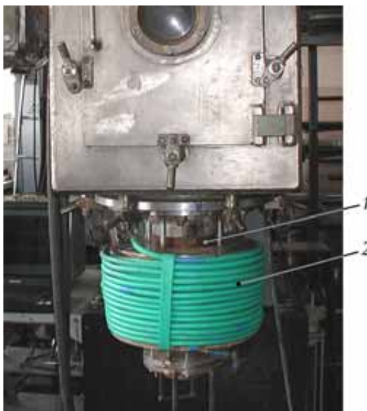
Рисунок 5.2 – Електромагнітна система для ЕШП в поздовжньому магнітному полі: 1 – кристалізатор; 2 – водоохолоджувані обмотки електромагнітної системи
