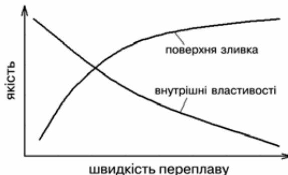
Рисунок 1.7 – Залежності якості поверхні зливку і його внутрішніх властивостей від швидкості переплаву при ЕШП
