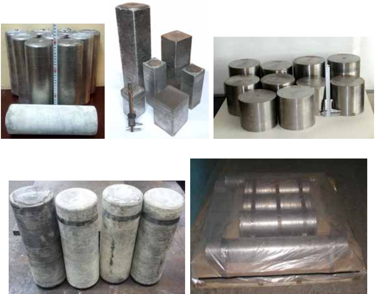
Рисунок 7.7 – Зливки титанових сплавів технології ЕШП (сплави Ti-Fe-Si, Ti-6-4, BT22, Ti-Fe-Si-W, Ti-10-2-3)
