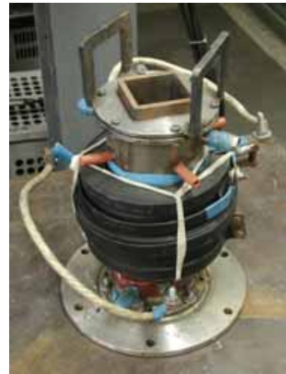
Рисунок 5. 21 – Принципова схема (а) і зовнішній вигляд (б) соленоїду з дисковими обмотками: H , K – початок та кінець обмотки; 1 – витки соленоїда; 2 – контакти перемички
