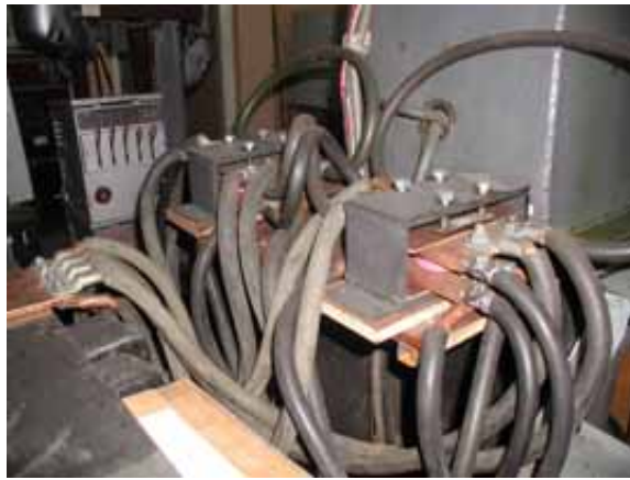
Рисунок 5. 25 – Зовнішній вигляд водоохолоджуваних діодних блоків для плавки постійним струмом з використанням трансформатора ТШП-10000
