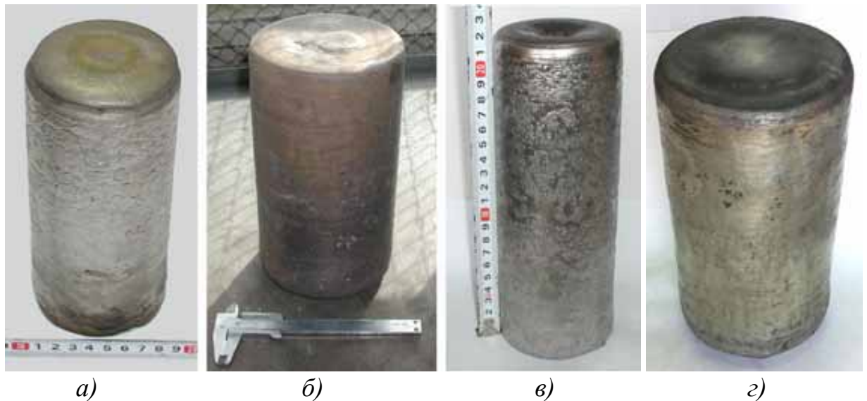
Рисунок 7.15 – Зливки прецизійних сплавів, отримані ЕШП відходів: a – 29НК; б – 50Н; в – 46Н; г – 49НФ
