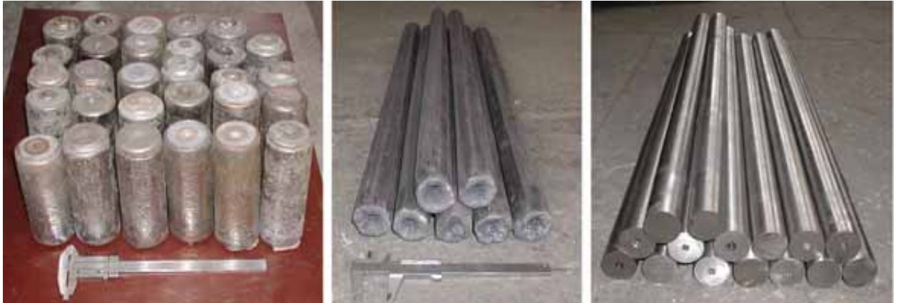
Рисунок 7.17 – Зливки прецизійного сплаву 29НК технології ЕШП та виготовлені з них поковки та прутки
