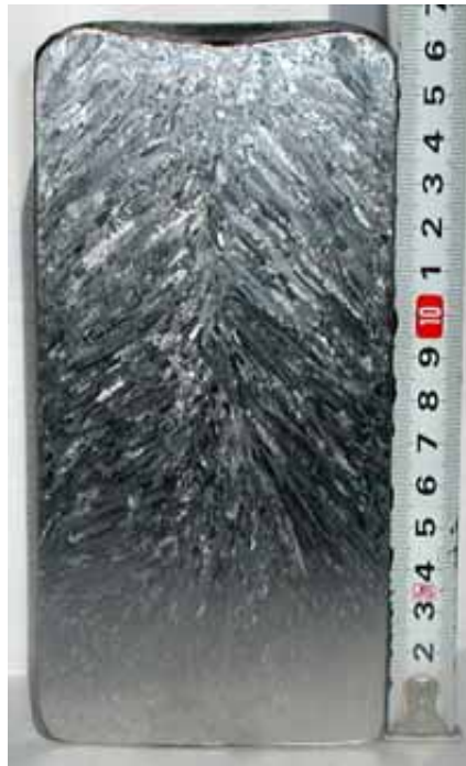
Рисунок 3.13 – Макроструктура титанового зливка \varnothing 84 мм, виплавленого традиційним ЕШП без зміни потужності
