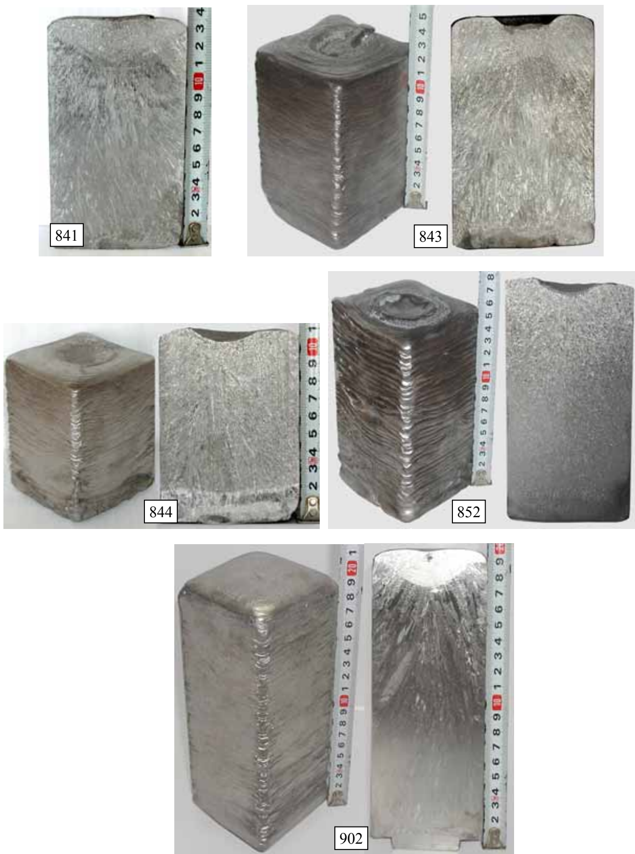
Рисунок 5.26 – Зовнішній вигляд та макроструктура титанових зливків, виплавлених з розрядами конденсаторів на ванну (цифрами вказані номери плавок)
