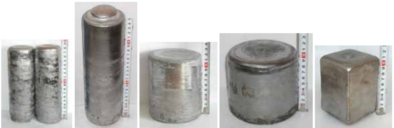
Рисунок 7.10 – Зливки TiNi технології ЕШП: зліва направо – \varnothing 64 , \varnothing 84 мм (I-й переplав), \varnothing 105 , \varnothing 120 , \square 80 \times 80 мм (II-й переplав)
