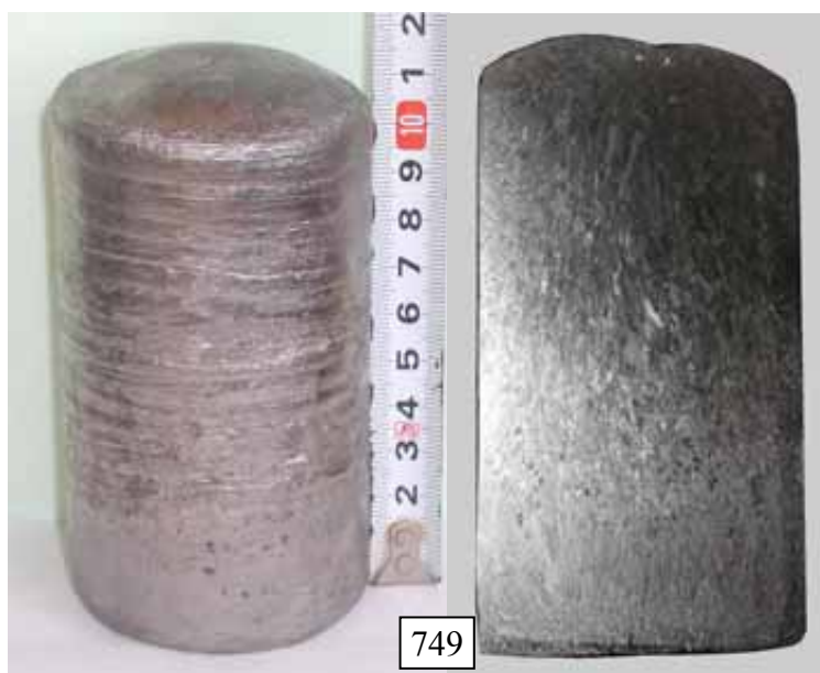
Рисунок 5.31 – Зовнішній вигляд та макроструктура титанових зливків \varnothing 65 мм, виплавлених з використанням розрядів конденсаторів на зовнішній магнітний контур (цифрами вказані номери плавок)
