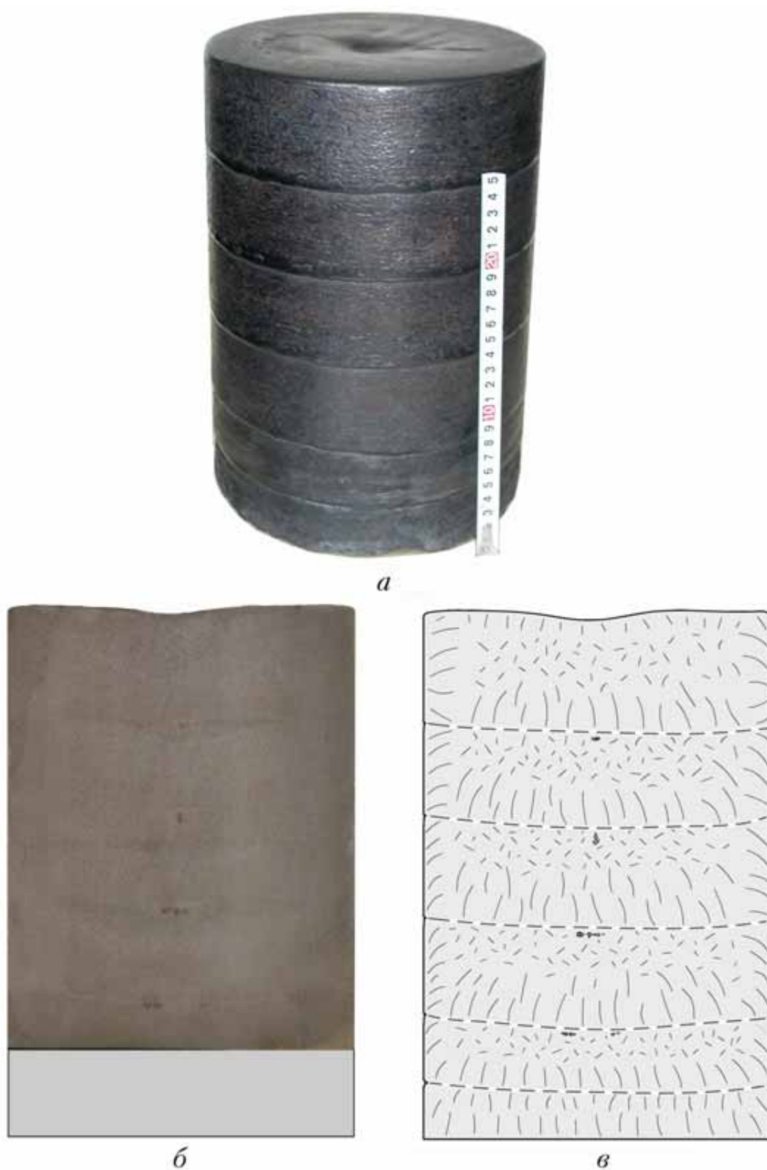
Рисунок 4.20 – Зовнішній вигляд (а), макроструктура (б) та схема кристалізації (в) зливка № 929
