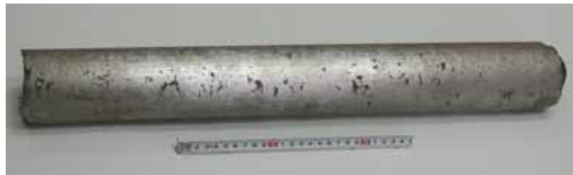
Рисунок 6.13 – Спресований з губчастого титану витратний електрод діаметром 75 мм
