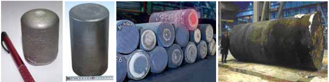
Рисунок 1.1 – Зливки ЕШП вагою від 0,5 кг до 250 тон
