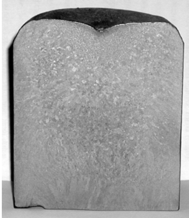
Рисунок 7.11 – Типова макроструктура зливка Ti-55Ni (мас.%) діаметром 105 мм другого переплаву
