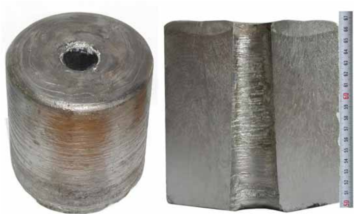
Рисунок 7.6 – Зовнішній вигляд (а) і макроструктура (б) порожнистого титанового зливка ЕШП
