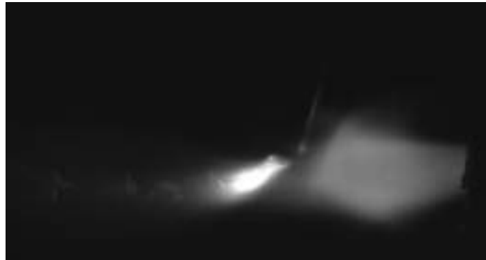
Рис. 3.1. Формування первинних крапель з рідкого прошарку на торці дроту при плазмово-дуговому розпиленні струмопровідного дроту
