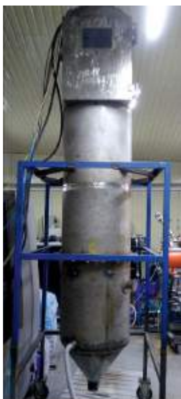
Рис. 5.16. Зовнішній вигляд установки для отримання гранул за технологією плазмово-дугового розпилення
