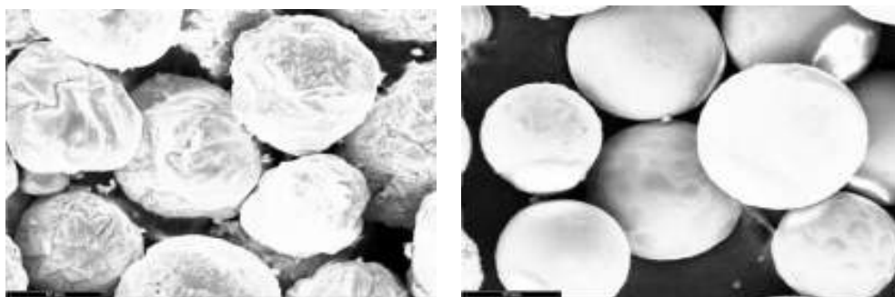
Рис. 5.21. Зовнішній вигляд процесу плазмово-дугового розпилення струмопровідного компактного дроту AISI 304 в камері розпилення у атмосфері аргону
