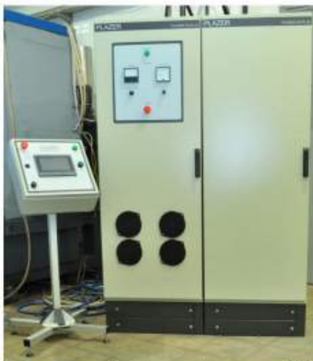
Рисунок 1. Зовнішній вигляд напівавтоматичної установки «PLAZER 50-PL-W» для плазмово-дугового напилування струмопровідним дротом-анодом
