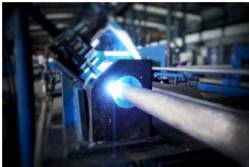
Рис. 5.28. Процес плазмово-дугового напилення струмопровідних дротів на трубу поверхні нагріву компанії «Zibo KNC Petroleum Equipment Co., Ltd» (КНР) для підприємства «Pourin Special Welding Technology Co., Ltd» (КНР)
