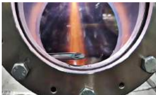
Рис. 5.21. Зовнішній вигляд процесу плазмово-дугового розпилення струмопровідного компактного дроту AISI 304 в камері розпилення у атмосфері аргону
