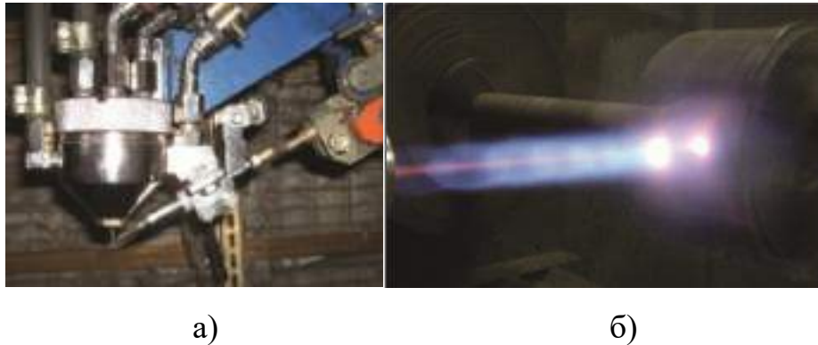
Рис. 1.3. Зовнішній вигляд надзвукового металізатору (а) та надзвукового струменя (б)
