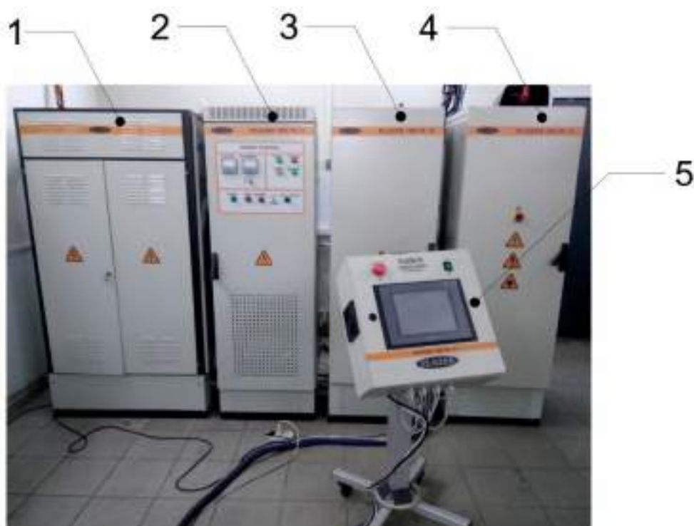
Рис. 2.1. Зовнішній вигляд лабораторної установки PLAZER 30-PL-W, де: 1 – трансформаторне джерело живлення основної дуги; 2 – тиристорний електропривід; 3 – трансформаторне джерело живлення чергової дуги; 4 – шафа керування та газопідготовки; 5 – мобільний пульти оператора з сенсорною панеллю
