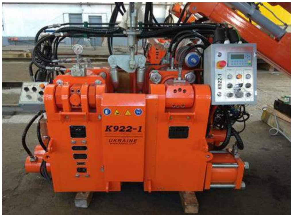
Рисунок 2.2 – Мобільна рейкозварювальна машина типу К922-1
