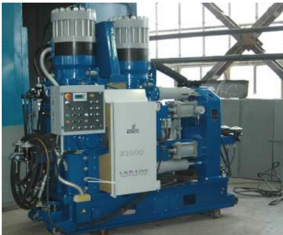
Рисунок 2.1 – Стационарна рейкозварювальна машина типу K1000
