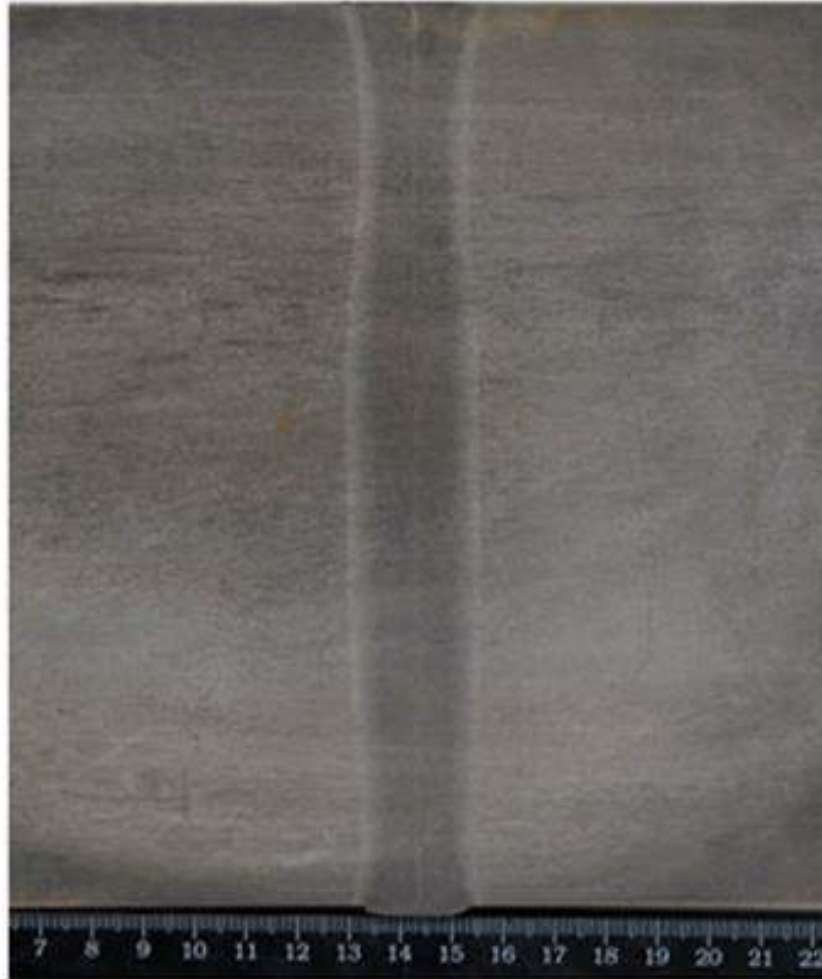
Рисунок 4.23 – Макрошліф з'єднання рейок R350HT при КСЗО, режим 2
