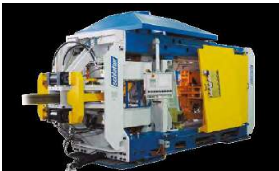
Рисунок 1.9 – Стационарна рейкозварювальна установка Schlatter GAAS 80 [96]
