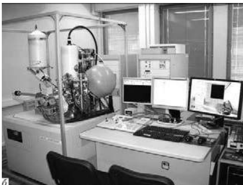
Рисунок 2.4 – Загальний вигляд оптичного мікроскопу “Neophot-32” (а), Оже-мікрозонда JAMP-9500F (б)
