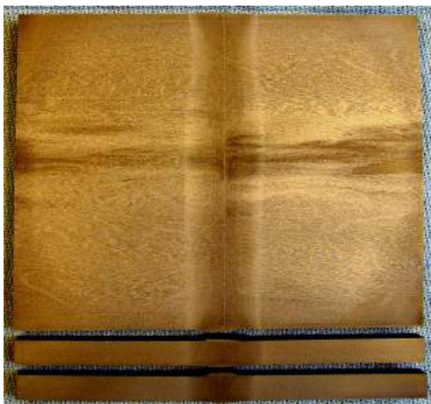
Рисунок 1.10 - Макроструктура зварного з'єднання, звареного КСЗО з підгрівом опором на зварювальній машині Schlatter GAAS 80 [96]
