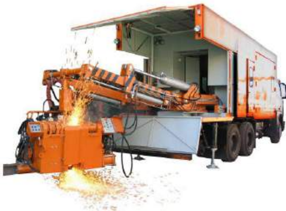
Рисунок 2.3 – Рейкозварювальна машина типу K922-1 на базі локомотива (а), вантажівки (б)
