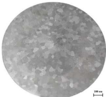
Рисунок 12 - Макроструктура зливка Ø1100 мм Grade 3
