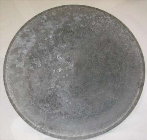
Рисунок 21 - Макроструктура зливка Ø600 мм ВТ9 з оплавленою
