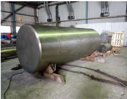
Рисунок 11 - Зовнішній вигляд зливка титану марки Grade3 Ø1100мм після механічної обробки.
