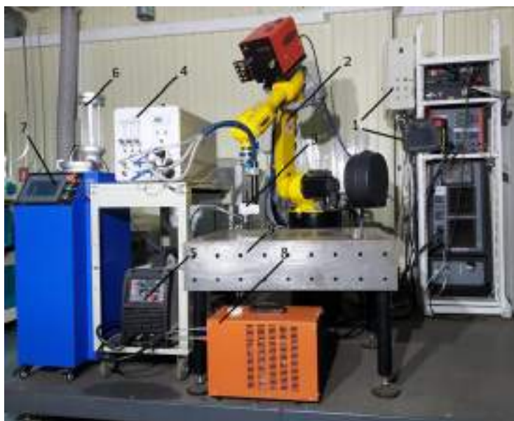
Рис. 5.14. Роботизований комплекс обладнання для автоматичного 3D друку металевих об'єктів невеликих і середніх розмірів, лімітованих вильотом руки робота до 1400 мм (впроваджено в ТОВ «Науково-виробничий центр ПЛАЗЕР, Україна, 2021 р.).
