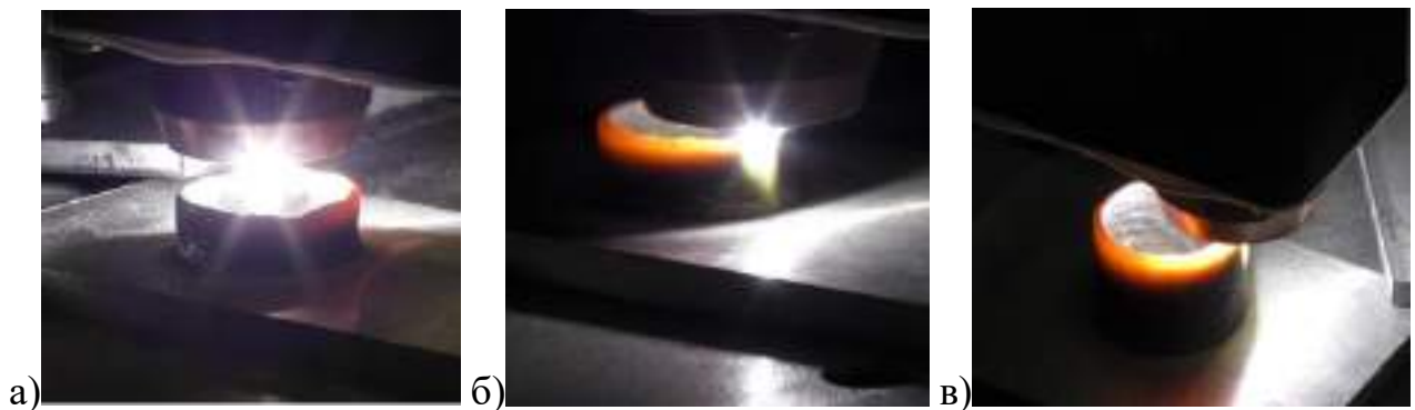
Рис. 5.5. Процес пошарового адитивного мікроплазмового наплавлення на створеному технологічному комплексі.
