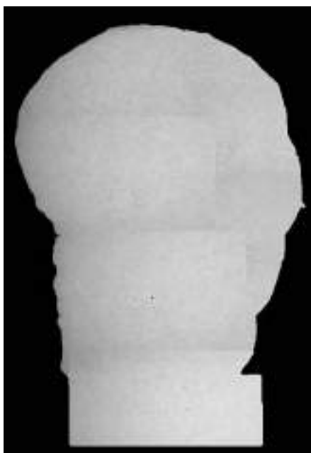
Рис. 3.31. Макроструктура поперечного перетину стінки, отриманої за допомогою MAG-наплавлення сталевго дроту Св-08Г2С.
