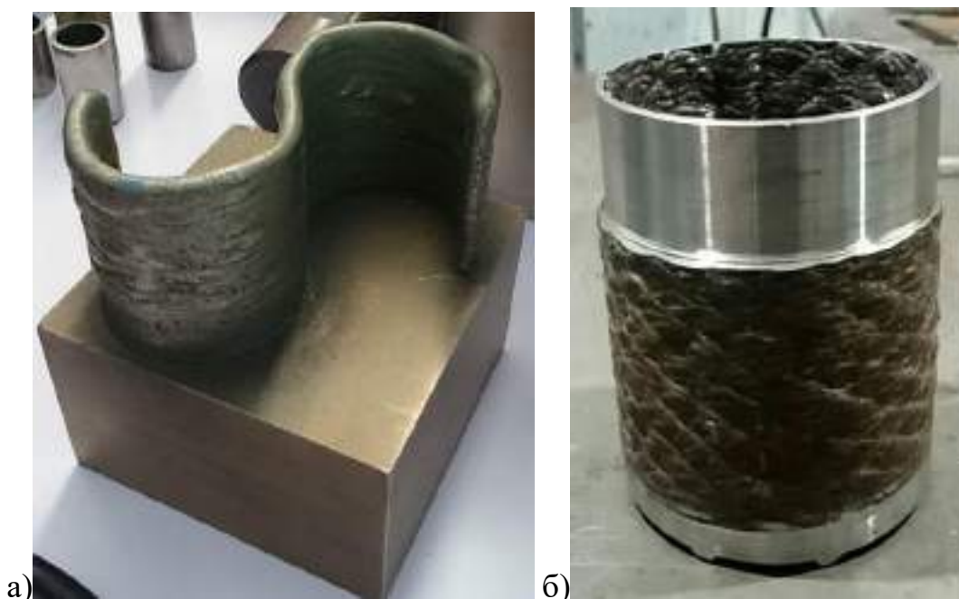
Рис. 3.28. Виготовлена адитивним мікроплазмовим наплавленням S-подібна стінка (а) із застосуванням порошку HYF-103 і виготовлений адитивним MAG наплавленням стакан (б) із застосуванням дроту Св-08Г2С з подальшою токарною обробкою.
