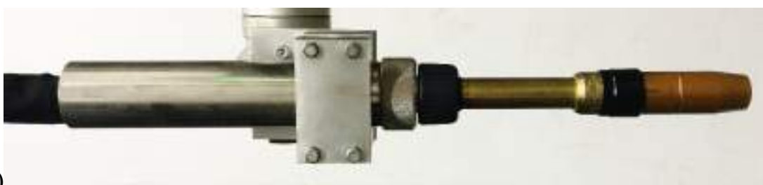
Рис. 2.7. 3D модель (а) і загальний вигляд (б) пальника для реалізації адитивної електродугової технології наплавлення плавким електродом.
