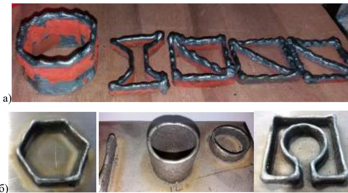
Рис. 5.1. Приклади адитивного мікроплазмового порошкового наплавлення базових просторових прототипів і довільних об'єктів з порошку ПЖ1 (а) та НУФ-103 (б)
