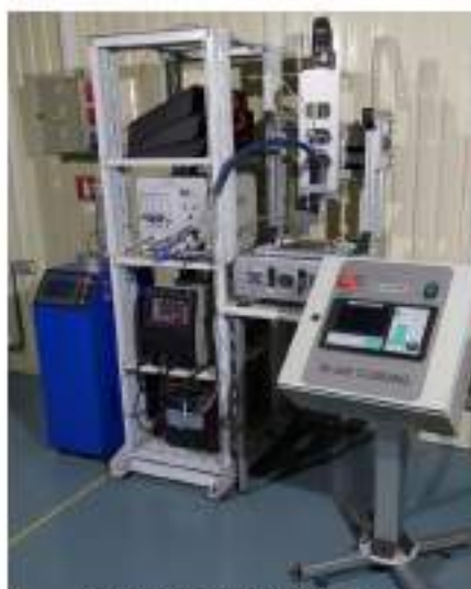
Комплекс обладнання для автоматизованого 3D друку металевих об'єктів розміром до 500×400×400 мм на базі 3D маніпулятора
