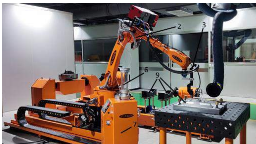
Рис. 5.15. Роботизований комплекс обладнання для 3D друку крупногабаритних металевих об'єктів із вильотом руки робота до 1800 мм і системою переміщення робота до 3000 мм (Науково-дослідний Інститут зварювальних технологій в провінції Чжецзян, м. Ханчжоу, КНР, 2022 рік).
