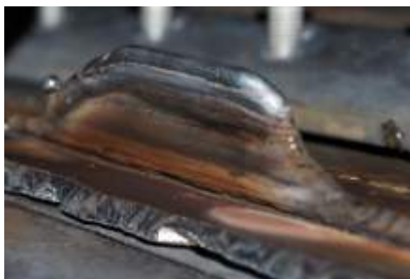
Рис. 3.27. Візуалізація адитивного процесу виготовлення тривимірної стінки товщиною 3 мм мікроплазмовим наплавленням присаджувальним сталевим дротом марки Св-08Г2С.
