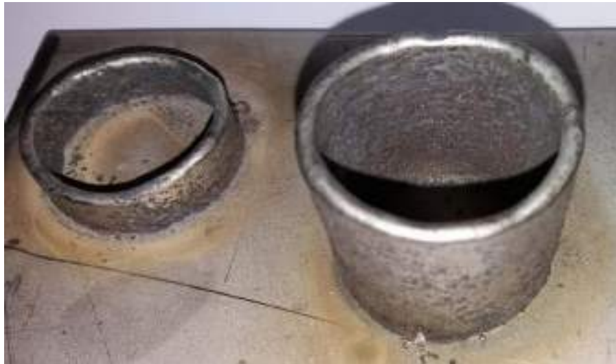
Рис. 4.11. Приклад мікроплазмового адитивного наплавлення виробу типу «циліндр»: зліва – застосування модельованого напружено-деформованого стану; справа – поєднання модельованого напружено-деформованого стану із додатковим аналізом накопичених статистичних даних.
