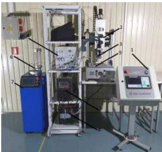
Рис. 5.12. Комплекс обладнання для автоматичного 3D друку металевих об'єктів розміром до 500 \times 400 \times 400 мм на базі 3D маніпулятора (впроваджено в ТОВ «Науково-виробничий центр ПЛАЗЕР Україна, 2020 р.).
