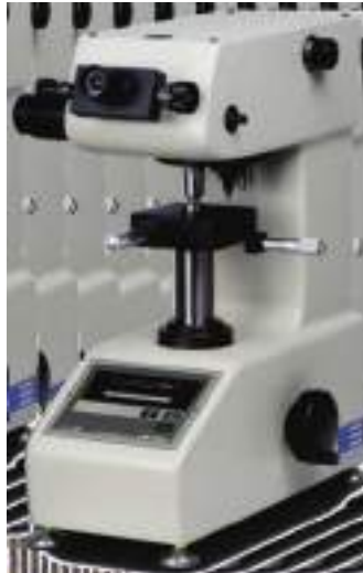
Рис.2.17. Зовнішній вигляд мікротвердоміра LM-400 (серія LECO).
