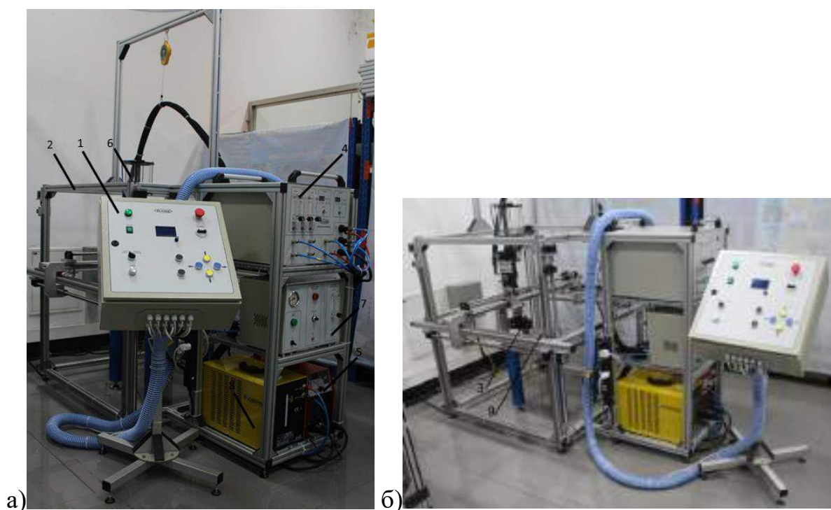
Рис. 5.13. Комплекс обладнання для автоматичного 3D друку металевих об'єктів розміром до 1000 \times 900 \times 900 мм на базі 3D принтера (введено в експлуатації в 2018 році в Південно-китайському технологічному університеті, м. Гуанчжоу, КНР).
