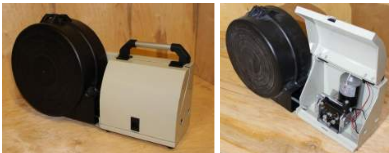
Рис. 2.10. Загальний вигляд блоку подачі дроту для реалізації адитивних плазових (мікроплазових) технологій наплавлення.
