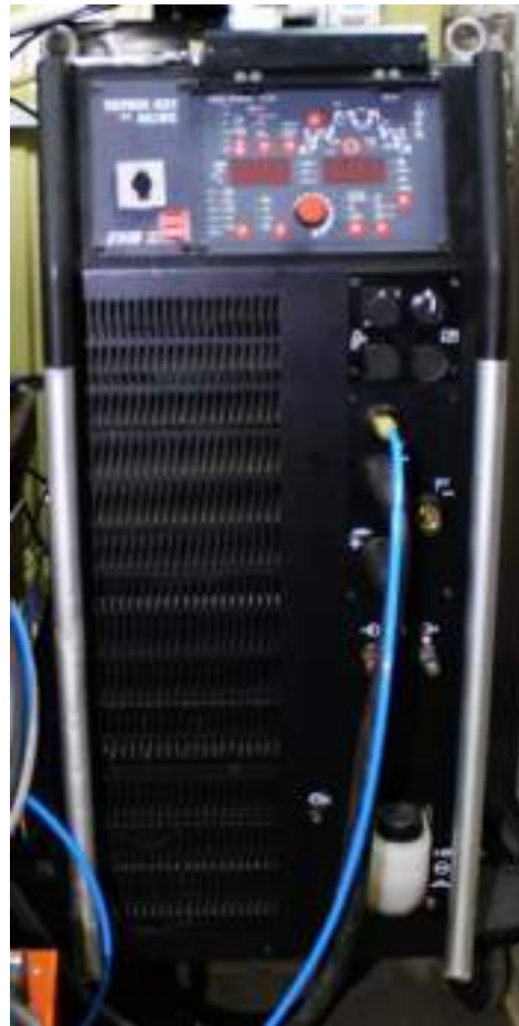
Рис. 2.8. Загальний вигляд джерела живлення для плазмового (мікроплазмового) зварювання (наплавлення) у складі універсального лабораторного комплексу для дослідження адитивних технологій наплавлення.
