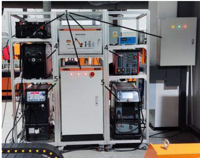
Рис. 5.16. Стійка із джерелами живлення робота, мікроплазмотрона, шафою адаптації команд для робота і інтелектуальною автоматичною системою моніторингу роботизованого комплексу, представленого на рис 5.15.
