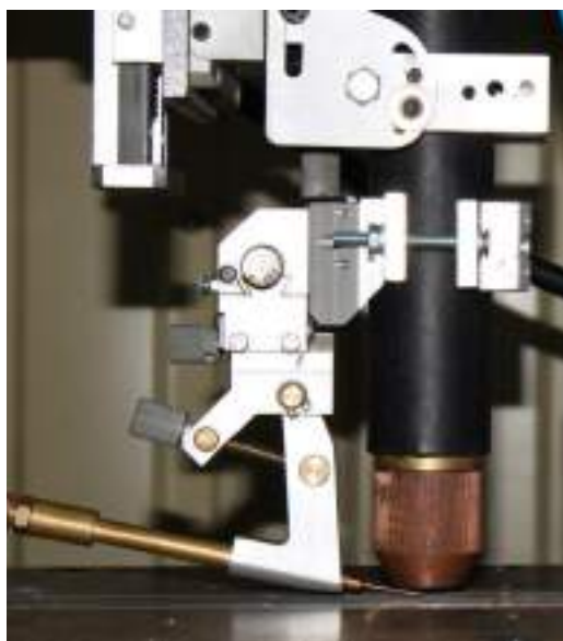
Рис. 2.11. Загальний вигляд плазмотрона з позиціонером дроту.
