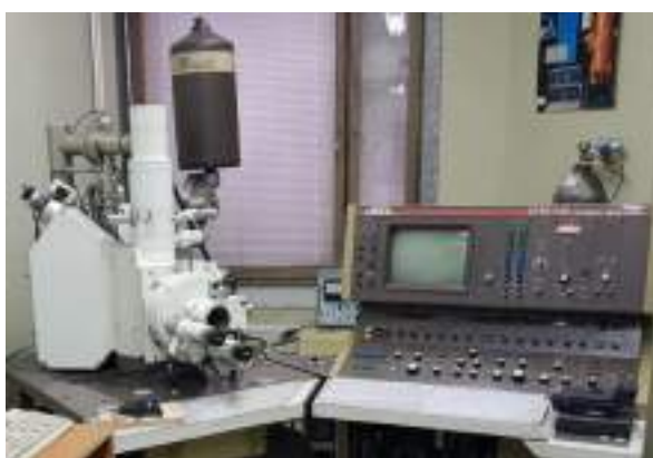
Рис.2.16. Зовнішній вигляд аналітичного растрового електронного мікроскопа JSM-840.
