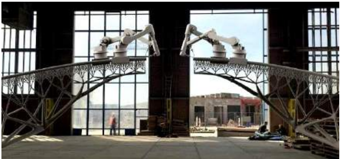
Рис. 1.5. Процес виготовлення мосту за допомогою зварювального 3D-принтера [30].
