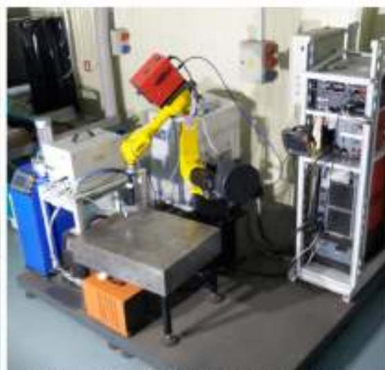
Роботизований комплекс обладнання для автоматизованого 3D друку металевих об'єктів невеликих і середніх розмірів з вильотом руки робота до 1400 мм
