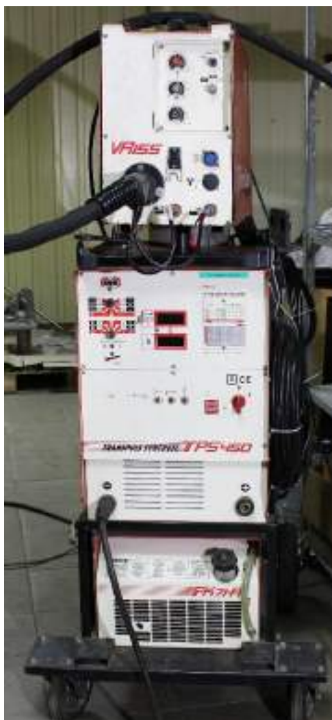
Рис. 2.6. Загальний вигляд апарату для наплавлення плавким електродом Fronius TPS 450 з механізмом подачі дроту.
