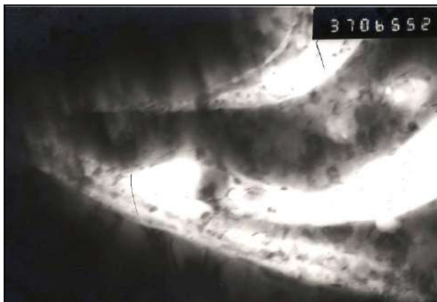
Рисунок 3.24 – Структура покриттів \text{Cr}_3\text{C}_2\text{-NiCr} (режим 3) на відстані \delta \sim 200 \dots 300 мкм від підкладки (а \times 50000 ; б, в \times 37000 ; г, д \times 50000 ; е \times 37000 )
