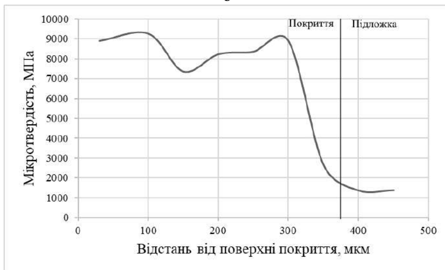
Рисунок 3.19 – Зміна інтегральної мікротвердості покриттів \text{Cr}_3\text{C}_2\text{-NiCr} , напилених на режимах: а – режим 1; б – режим 2, в – режим 3.
