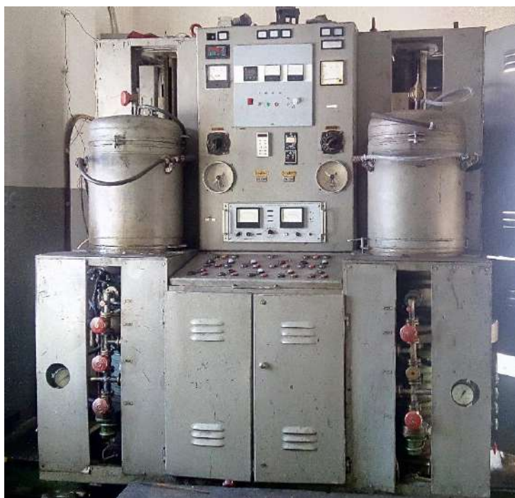
Рисунок 2.2 - Вакуумна піч СГВ 2,4-2/ 15-І3
