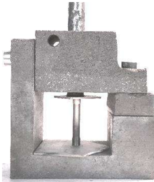
Рисунок 5.3 - Спеціальна оснастка для збирання та паяння макетних зразків
