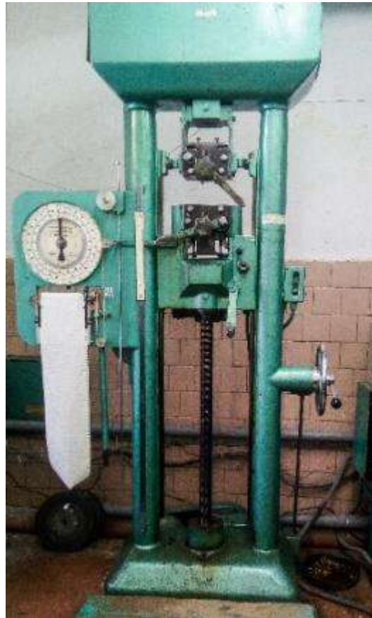
Рисунок 2.5 - Універсальна випробувальна машина ZDM 10
