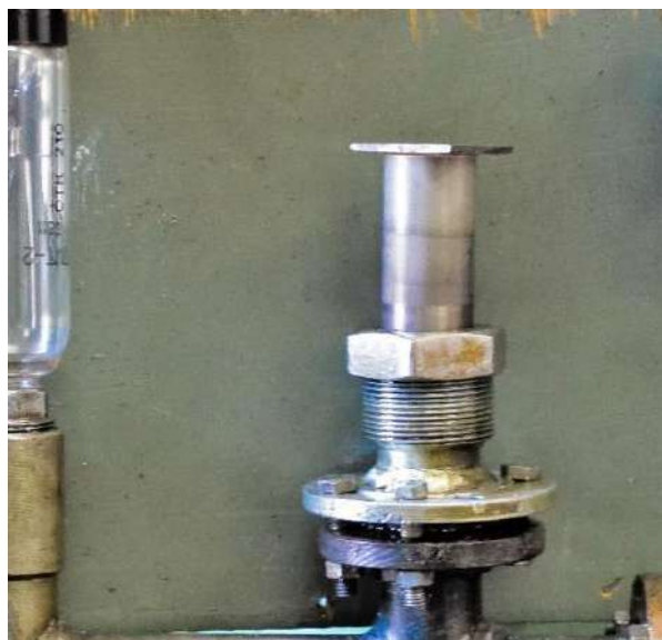
Рисунок 5.9 - Випробування дослідного зразка на вакуумну щільність
