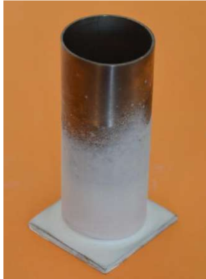
Рисунок 5.8 - Дослідний паяний зразок імітатор «трубка + фланець» після газової проби
