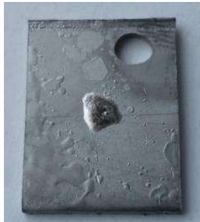
Рисунок 3.24 – Зразок титанового сплаву VT-1-0 з хімічного нанесеним нікелевим покриттям зі слідами руйнування бар'єрного шару
