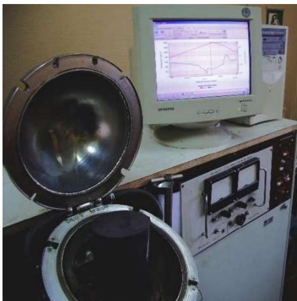
Рисунок 2.3 - Установка високотемпературного диференційного термічного аналізу ВДТА-8МЗ
