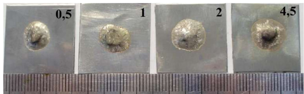
Рисунок 3.21 – Зовнішній вигляд зразків перед (а) і після (б) розтікання
