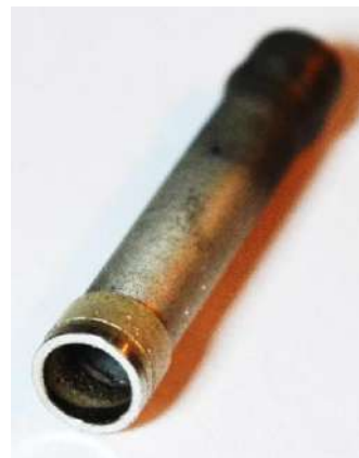
Рисунок 5.5 - Зовнішній вигляд паяних вузлів елементів корпусу фотоприймального пристрою: вузол «стійка+втулка \varnothing 6мм» ( а); вузол «стійка \varnothing 16мм +втулка+ заглушка» (б)
