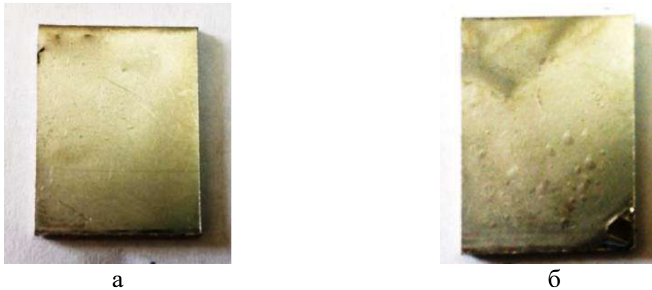
Рисунок 3.6 - Підкладка сплаву VT1-0, що покрита шаром нікелю електролітичним шляхом: а - до нагріву в вакуумі; б – після нагріву (вакуум 5 \cdot 10^{-5} мм. рт. ст., 500^{\circ}\text{C} , 3 год)
