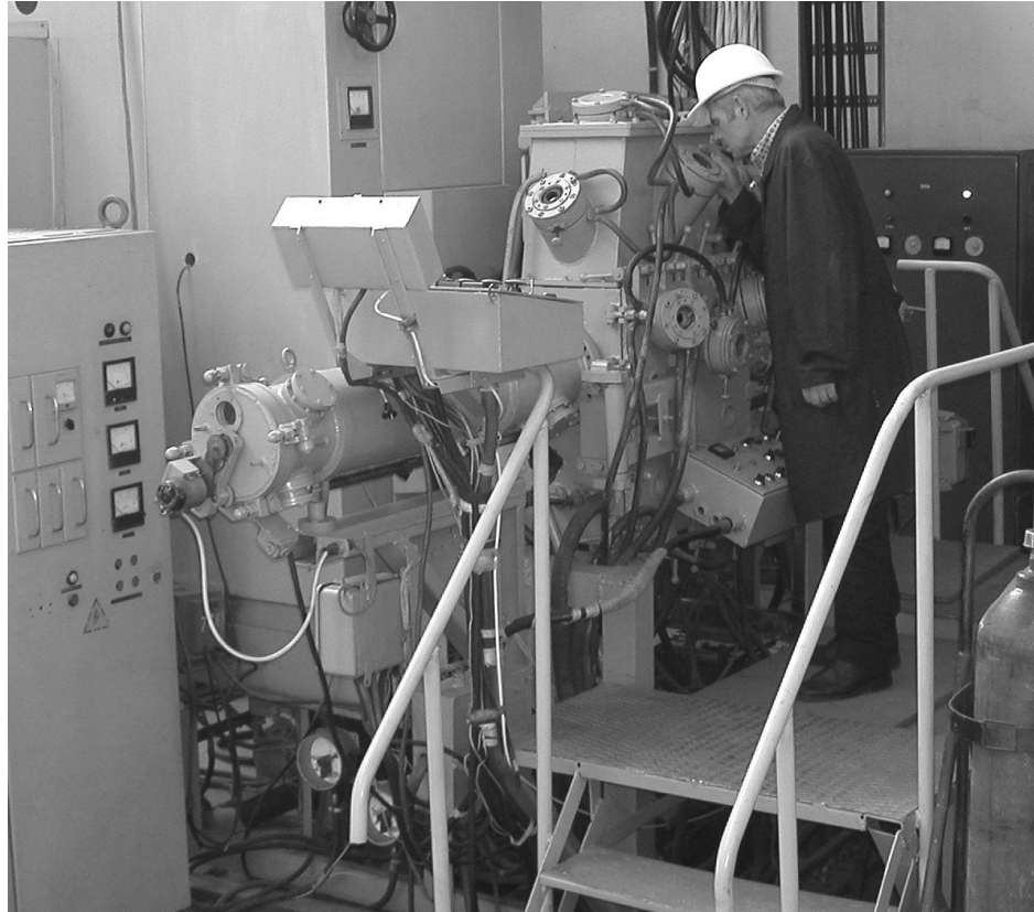
Рис. 2.1. Дослідно-промислова установка УП-122М для плазмово-індукційного вирощування монокристалів тугоплавких матеріалів (загальний вигляд)
