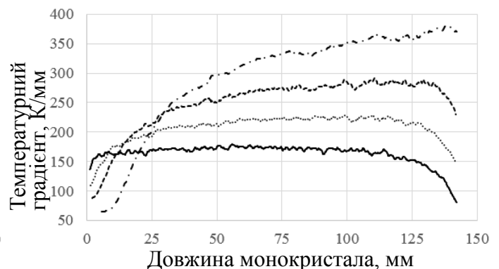
Рис.9. Температурні градієнти попереду металевої ванни в процесі її переміщення: — - 20 мм/хв, ..... - 80 мм/хв, -- - 160 мм/хв, -.-.- - 320 мм/хв.
