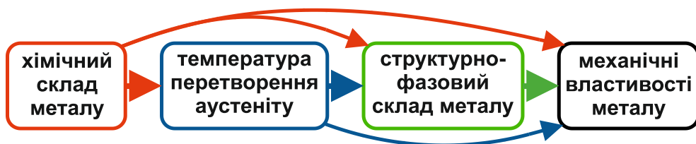
Рис.5.1 Взаємовплив хімічного складу, температури перетворення аустеніту, структурно-фазового складу на механічні властивості металу зварного шва.
