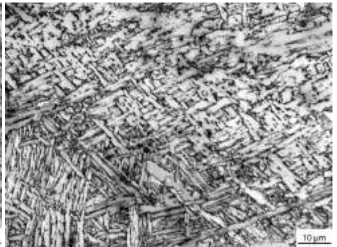
Рис.3.11 Мікроструктура металу шву, що модифіковано частинками MgO.
