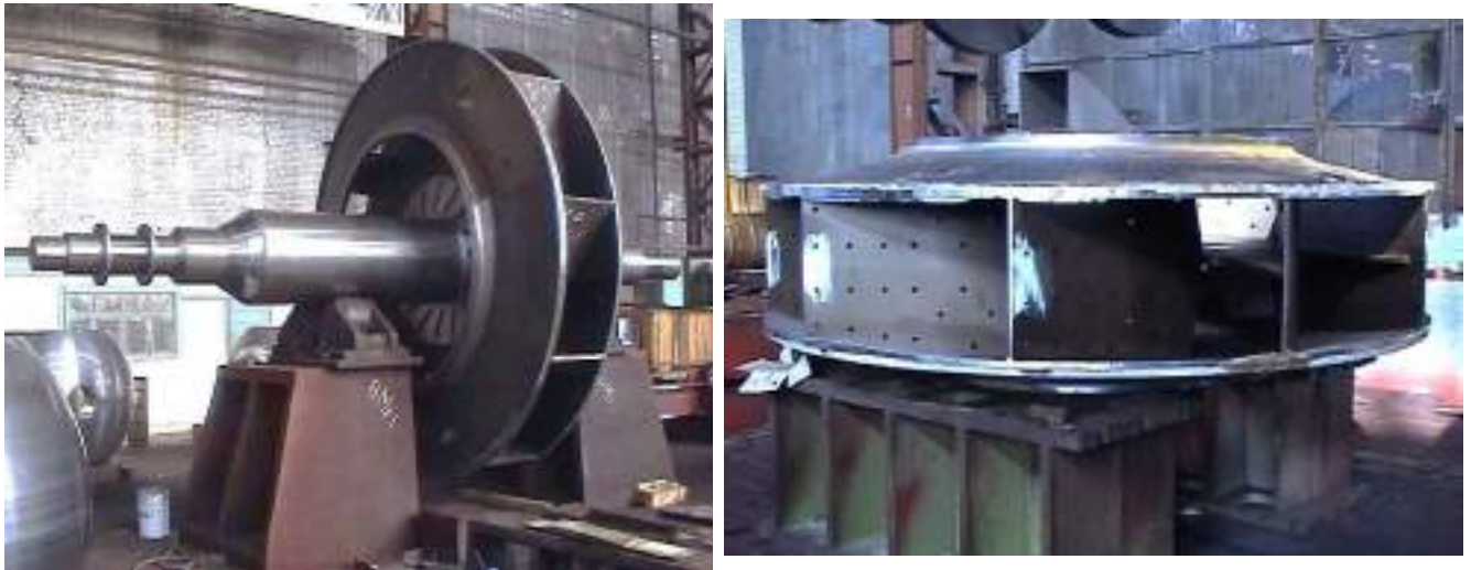
Рис.6.1 Ротор тягодувних радіальних машин: а) у зібраному вигляді; б) корпус ротора.
