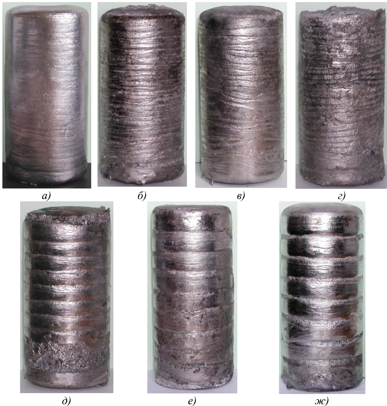
Рисунок 4.12 – Зовнішній вигляд титанових зливків виплавлених ЕШП з використанням поздовжнього імпульсного магнітного поля:
