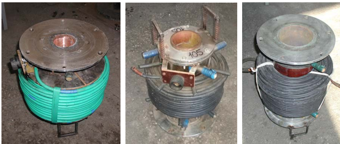
Рисунок 4.3 – Зовнішній вигляд кристалізаторів для ЕШП в поздовжньому магнітному полі діаметром 84, 105 і 144 мм.
