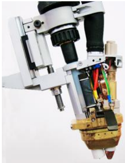
Рисунок 1.6 Гібридний пальник фірми WeldObot Ltd для плазмово-дугового зварювання плавким електродом алюмінієвих сплавів [76].
