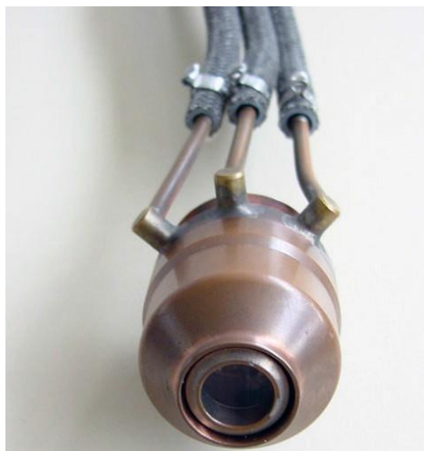
Рисунок 1.8 Плазмоутворююче та захисне газове сопло пальника PLM 500 фірми TBI для гібридного плазмово-дугового зварювання плавким електродом [108].
