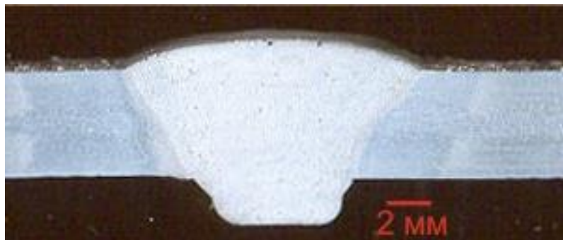
Рисунок 4.2 Поперечний перетин зварного шва листів товщиною 5 мм зі сплаву 1561, отриманого імпульсним зварюванням плавким електродом
