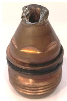
Рисунок 5.4 Фото зруйнованих плазмових електродів дослідного плазмотрону.
