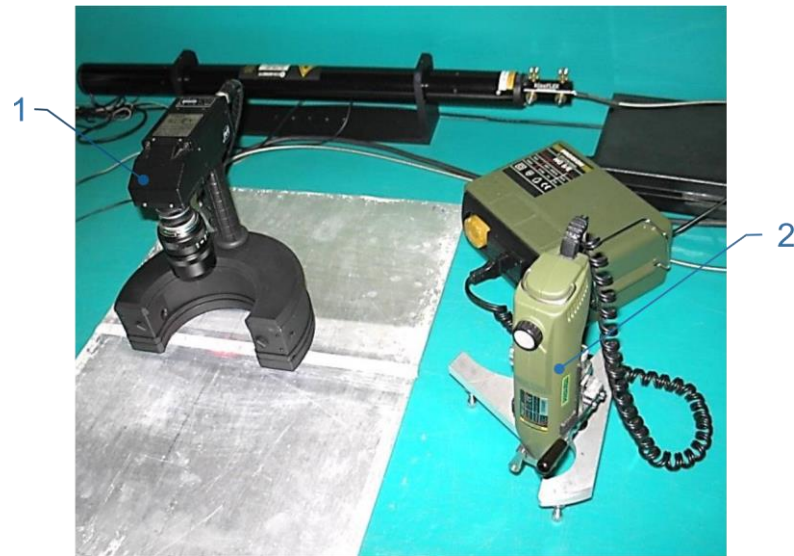
Рисунок 2.13 Вимірювання залишкових напружень методом спекл-інтерферометрії на поздовжніх стикових зварних швах, де 1-інтерферометр, 2-пристрій для свердлення, 3-зразок зварного з'єднання.
