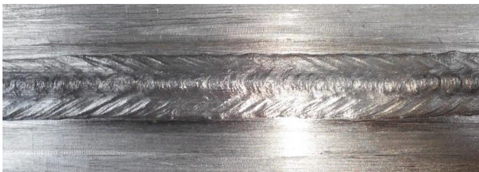
Рисунок 4.3 Зовнішній вигляд зварного шва зі сплаву 1561 товщиною 5 мм виконаний гібридним плазмово-дуговим зварюванням плавким електродом
