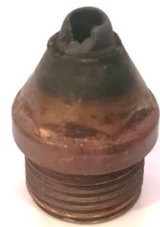
Рисунок 5.4 Фото зруйнованих плазмових електродів дослідного плазмотрону.
