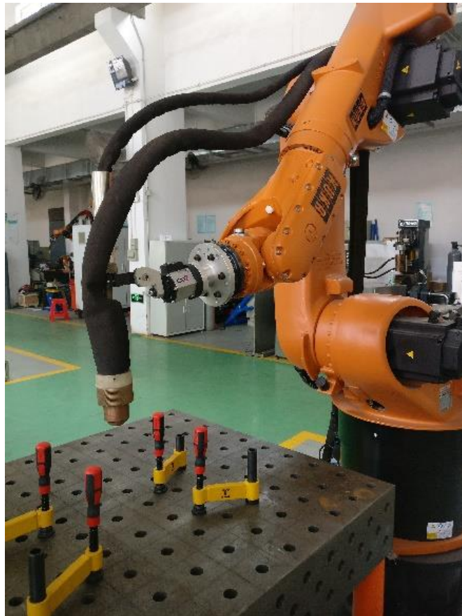
Рисунок 5.21 Плазматрон для гібридного плазмово-дугового зварювання плавким електродом зі зварювального комплексу «Plazer PW-Hybrid TC» закріплений на «руці» робота-маніпулятора Kuka KR60
