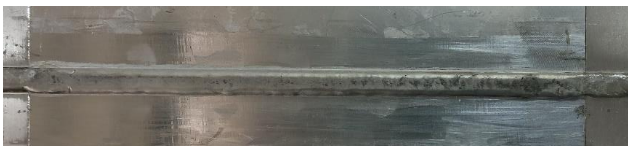
Рисунок 5.18 Фото лицьової (а) та зворотної (б) частини стикового зварного з'єднання пластин товщиною 8 мм з алюмінієвого сплаву 7075 виконаного гібридним плазмово-дуговим зварюванням плавким електродом на швидкості 40 см/хв
