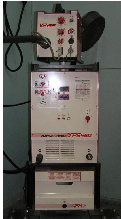
Рисунок 2.4 Апарат Fronius TPS 450 для зварювання плавким електродом з інверторним джерелом живлення
