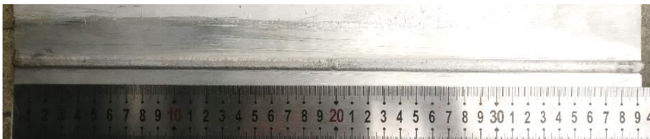
Рисунок 5.19 Фото лицьової (а) та зворотної (б) частини стикового зварного з'єднання пластин товщиною 8 мм з алюмінієвого сплаву 5083 виконаного гібридним плазмово-дуговим зварюванням плавким електродом на швидкості 40 см/хв
