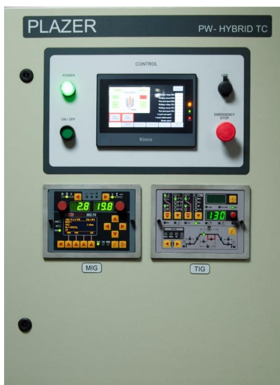
Рисунок 5.14 Зовнішній вигляд системи автоматизованого керування процесом гібридного плазмово-дугового зварювання плавким електродом.
