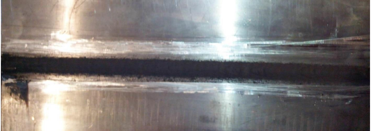
Рисунок 4.1 Зовнішній вигляд зварного шва листів товщиною 5 мм зі сплаву 1561, отриманого імпульсним зварюванням плавким електродом (одразу після зварювання)
