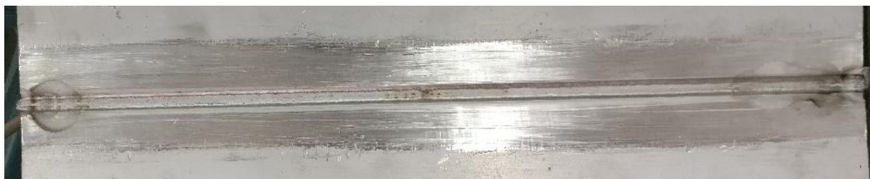
Рисунок 5.17 Фото лицьової (а) та зворотної (б) частини стикового зварного з'єднання пластин товщиною 8 мм з алюмінієвого сплаву 1561 виконаного гібридним плазмово-дуговим зварюванням плавким електродом на швидкості 40 см/хв
