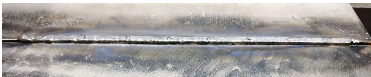
Рисунок 5.20 Фото лицьової (а) та зворотної (б) частини стикового зварного з'єднання пластин товщиною 12 мм з корозійностійкої сталі AISI 304 виконаного гібридним плазмово-дуговим зварюванням плавким електродом на швидкості 25 см/хв
