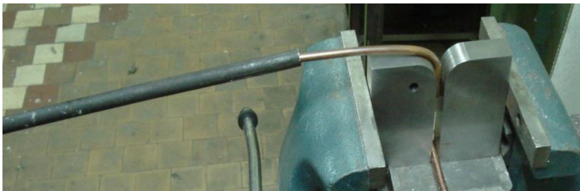
Рис 5.7 Випробування на міцність зчеплення алюмінію і міді
