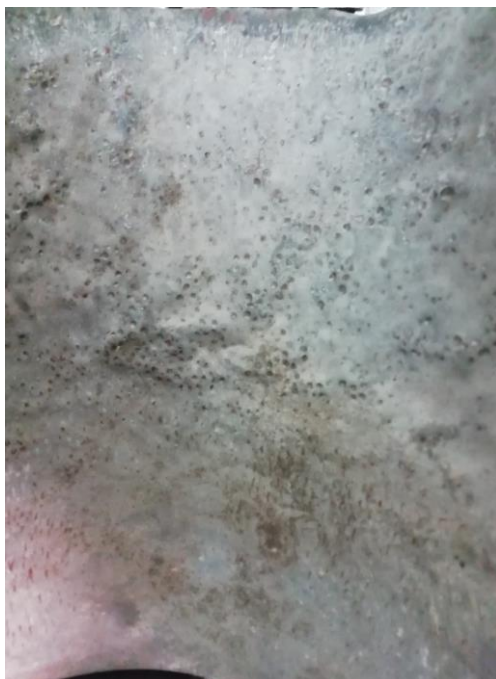
Рис. 5.12 Зовнішній вигляд відбитків наповнювача з металевого дробу на внутрішній стінці сталеві труби
