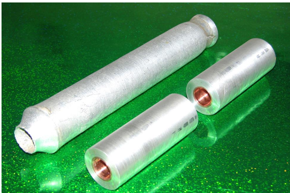
Рис. 5.18 Біметалічні заготовки після зварювання вибухом і токарної обробки
