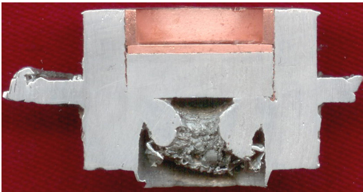
Рис. 5.20 Макрошліф біметалічної трубки, звареної зварюванням тертям з алюмінієвою трубкою
