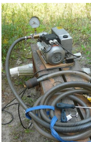
Рис. 2.6. Устаткування для вакуумування зварювального проміжку
