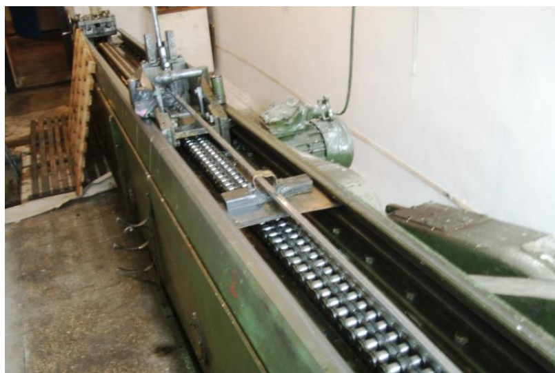
Рис. 2.1 Установка для протягання біметалевих стрижнів
