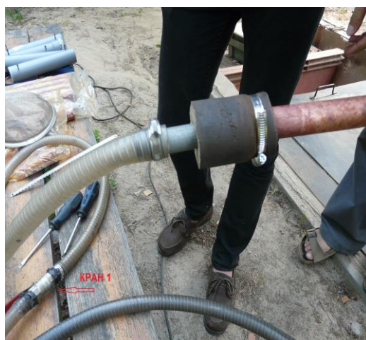
Рис. 2.6. Устаткування для вакуумування зварювального проміжку
