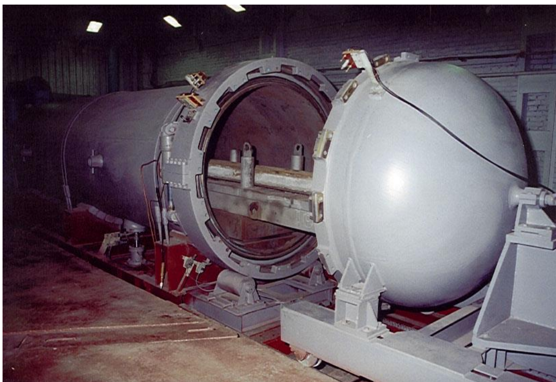
Рис. 1.7 Вибухова камера з висунутим робочим столом
