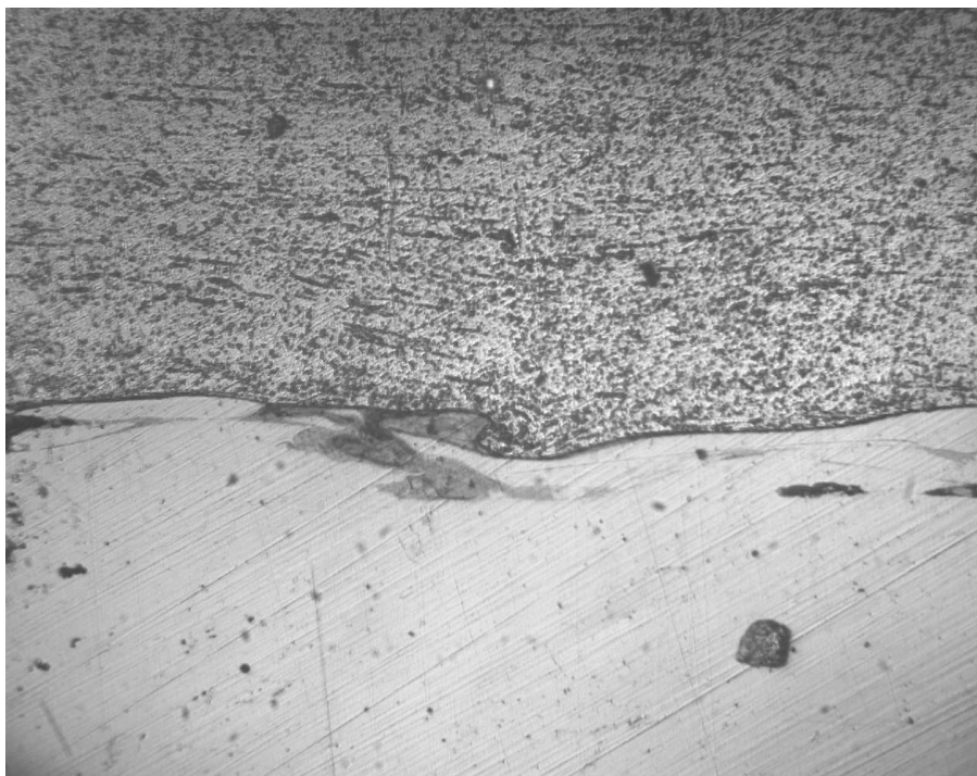
Рис. 5.17 Мікроструктура отриманого з'єднання (x100, алюміній зверху)
