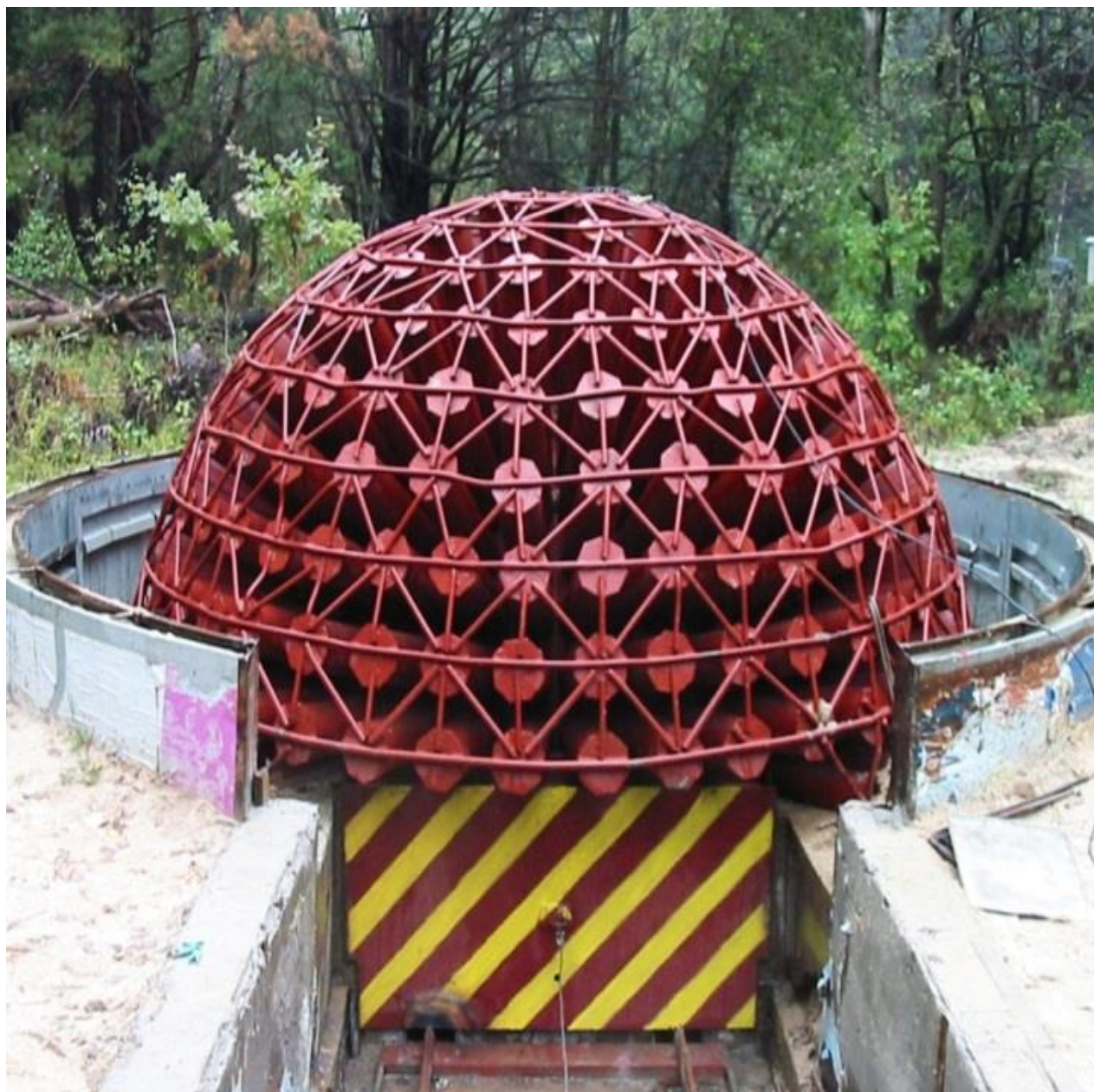
Рис. 4.21 Загальний вигляд трубчастої камери для зварювання вибухом
