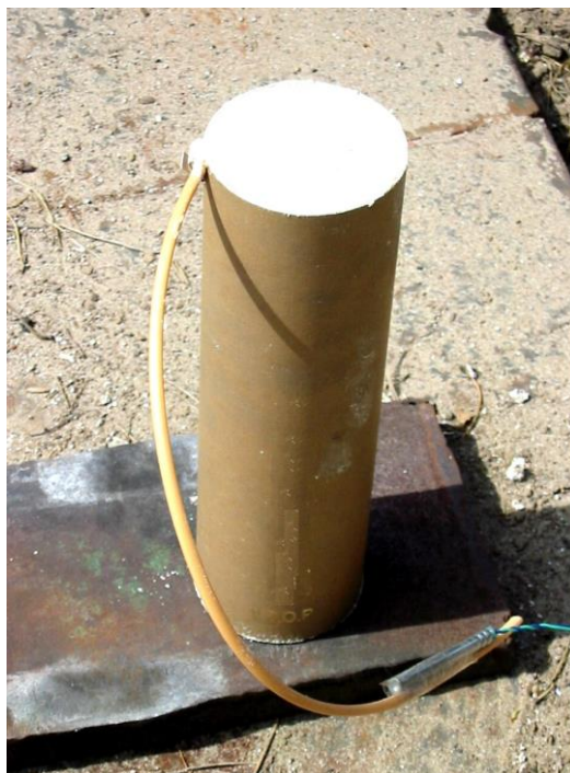
Рис. 5.14 Вигляд зборки для зварювання вибухом мідно-алюмінієвих біметалевих труб із засипаною вибуховою речовиною
