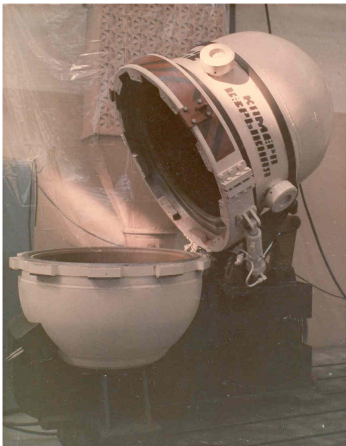
Рис. 1.6 Камера вибухова KB-02 (рухома частина корпусу піднята)
