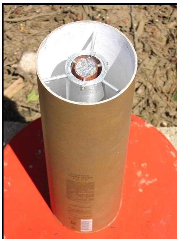
Рис. 5.13 Схема зборки для зварювання вибухом зі сталевим стрижнем залитим сплавом Вуда всередині мідної трубки
