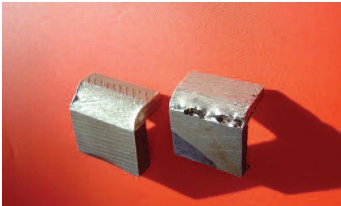
Рис. 1.9 Результати випробувань: зліва зразок, отриманий у вакуумній камері, а справа – на відкритому повітрі
