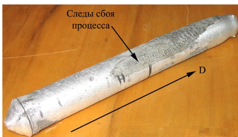
Рис. 5.15 Відбитки збою процесу детонації на поверхні алюмінієвої заготовки
