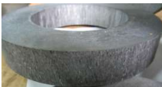
Рисунок 6.36 - Макроструктура трубної заготовки Ø190/90 мм із титанового сплаву VT14
