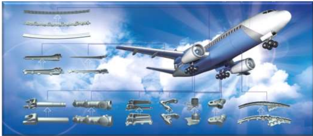
Рисунок 1.12 – Застосування сплавів титану у виробництві силових елементів крила і фюзеляжу літака
