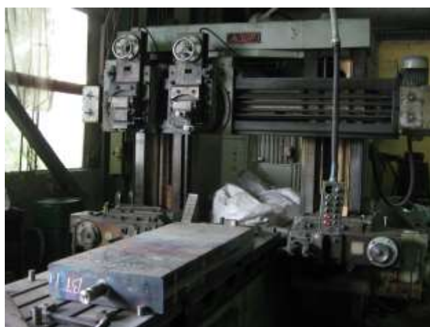
Рисунок 2.15 – Підготовка поверхні зливка на стругальному верстаті для спектрального аналізу
