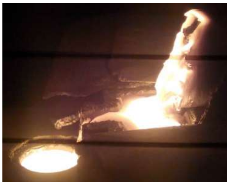
Рисунок 4.23 - Процес ЕПП: зливка \varnothing 110 мм титанового сплаву Т120
