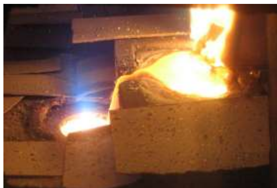
Рисунок 5.2 – Процес виплавки зливка \varnothing 110 мм сплаву титану TIMETAL LCB
