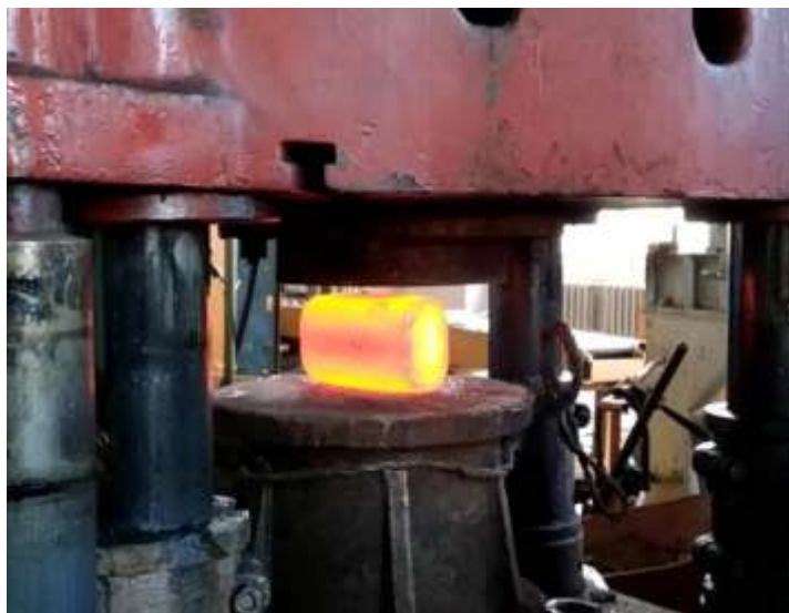
Рисунок 5.5 – Одержання заготовки 120 \times 120 \times 200 мм сплаву титана TIMETAL LCB
