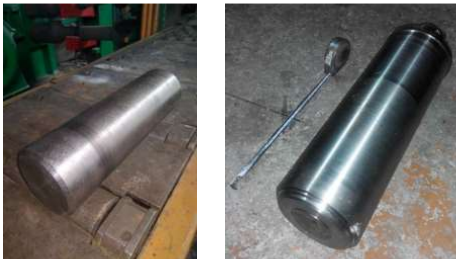
Рисунок 5.29 – Зовнішній вигляд зливку \varnothing 110 мм економнолегованого сплаву титану після токарної обробки їх поверхневого шару: а - \text{Ti-2,8Al-5,1Mo-4,9Fe} ; б - \text{Ti-1,5Fe-0,4O}
