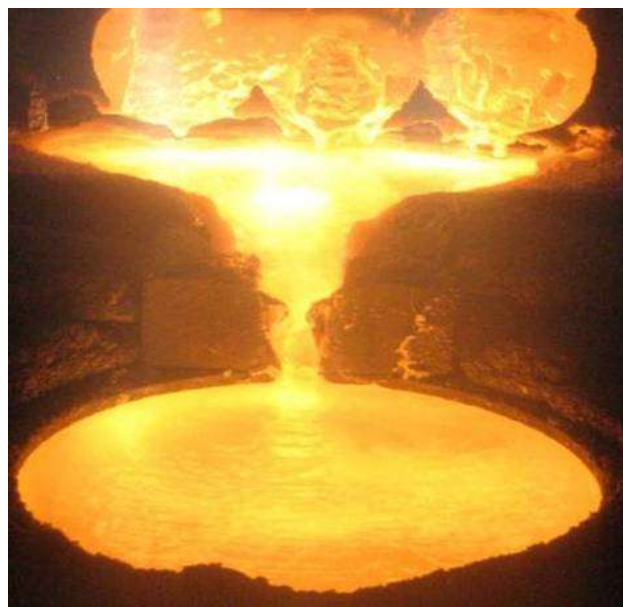
Рисунок 4.10 - Процес ЕПП зливка Ø400мм титанового сплаву ВТ22
