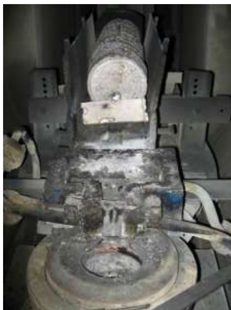
Рисунок 5.24 – Завантажена шихтова заготовка для плавки економнолегованого титанового сплаву Ti-1,5Fe-0,4O та технологічне обладнання електронно-променевої установки УЕ-208М
