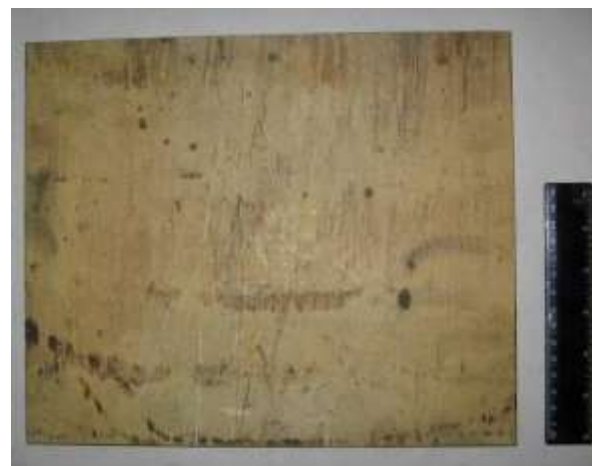
Рисунок 6.23 - Процес прокату (а) та отримані листи 350x300x6 мм (б) сплаву ВТ19
