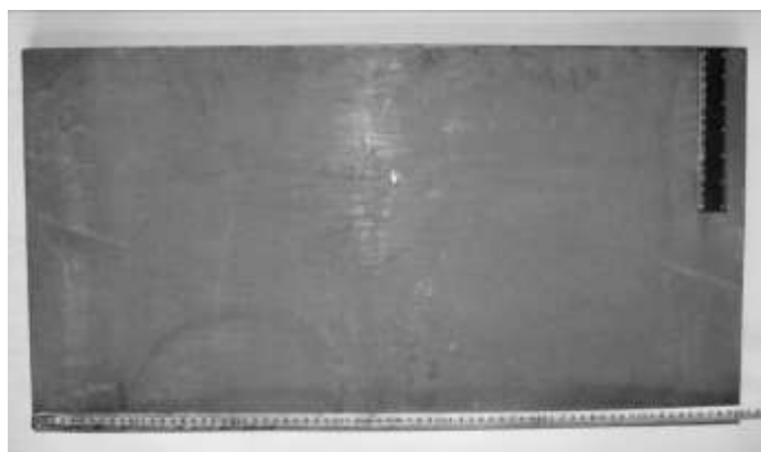
Рисунок 6.18 - Пластина 350 \times 700 \times 10 мм з титанового сплаву BT22
