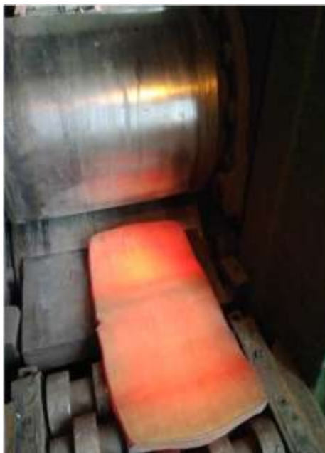
Рисунок 5.6 – Процес гарячої прокатки зливку сплаву титана TIMETAL LCB
