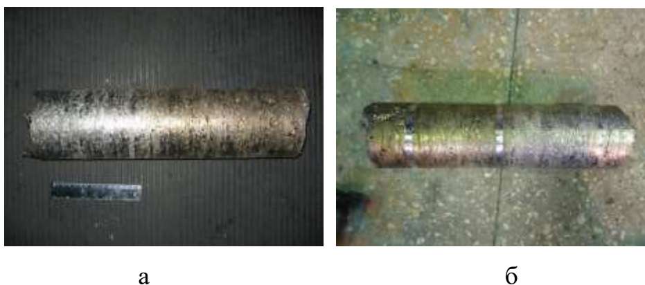
Рисунок 5.27 – Зовнішній вигляд зливків Ø110мм економнолегованих сплавів титану: а - Ti-2,8Al-5,1Mo-4,9Fe; б - Ti-1,5Fe-0,4O
