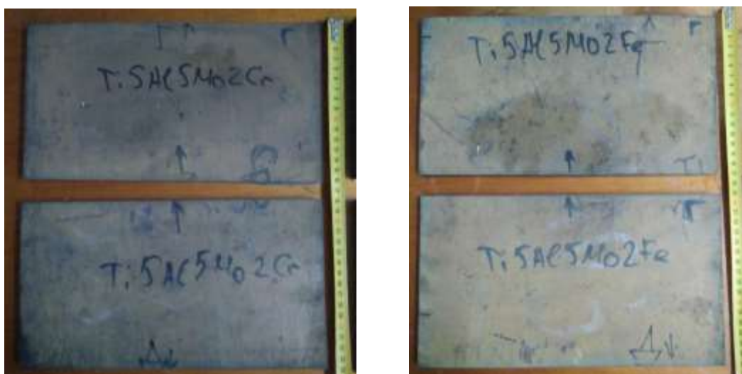
Рисунок 5.41 – Пластини 300 \times 160 \times 15 мм із сплавів \text{Ti-5Al-5Mo-2Fe} та \text{Ti-5Al-5Mo-2Cr}
