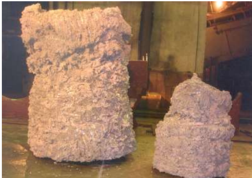
Рисунок 2.9 - Блок губчастого титану масою 3,8 тони в порівнянні з блоком масою 0,7 тон
