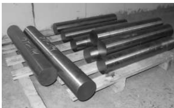
Рисунок 6.34 - Механічно оброблені ковані прутки \varnothing 190 мм із титанового сплаву ВТ14
