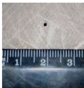
Рисунок 2.20 - Зразок еталону зливка \varnothing 400 мм зі стандартним дефектом
