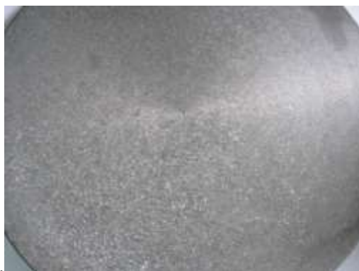
Рисунок 6.33 - Макроструктура кованого прутка \varnothing 200 мм із титанового сплаву ВТ14
