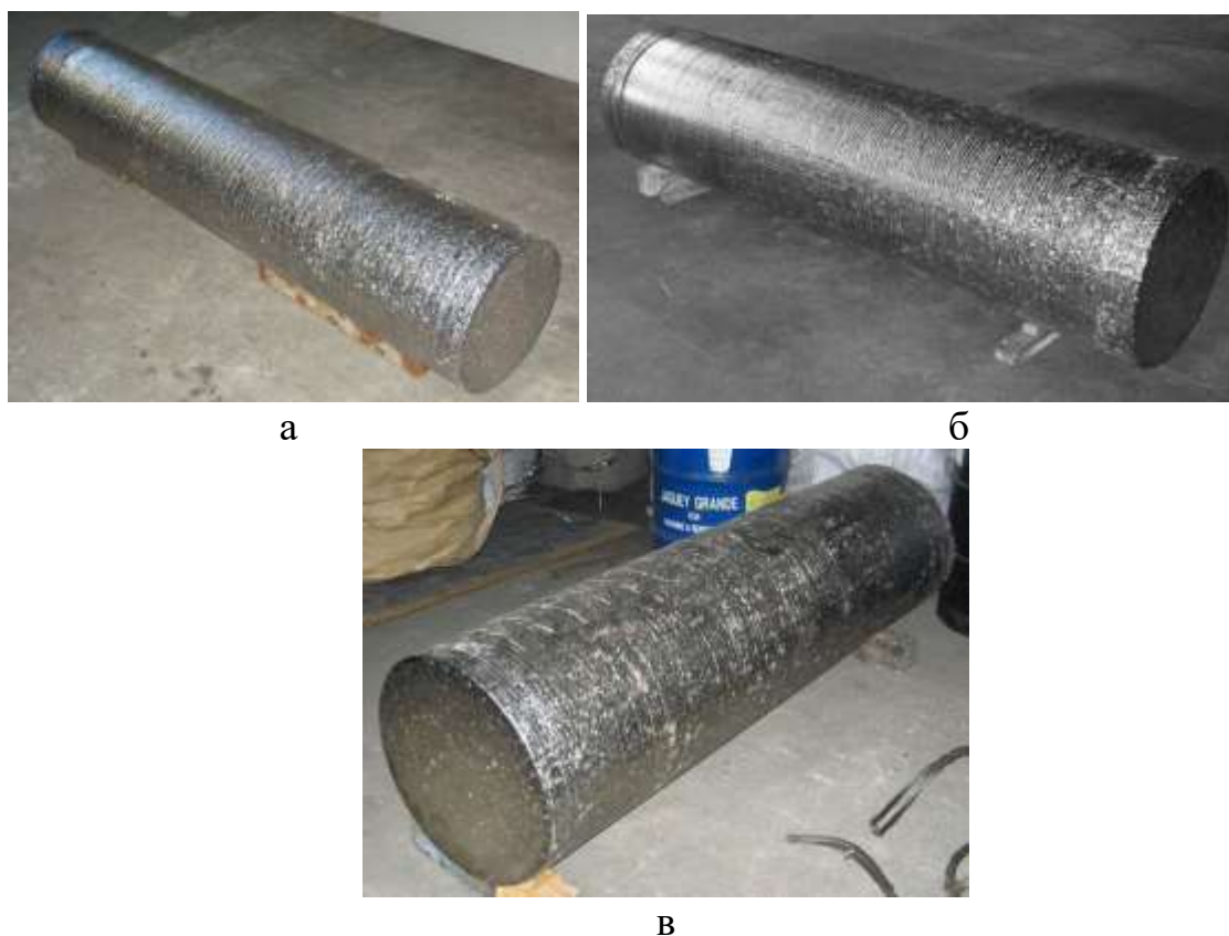
Рисунок 4.15 - Зливки високоміцних сплавів титану: а - \varnothing 400\text{ мм} VT22; б - \varnothing 400\text{ мм} VT23; в - \varnothing 600\text{ мм} VT14
