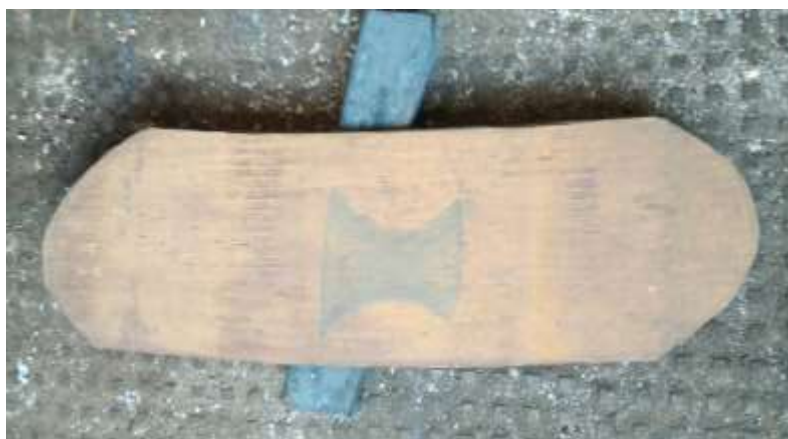
Рисунок 5.7 – Пластина 300×900×10 мм сплаву титана TIMETAL LCB
