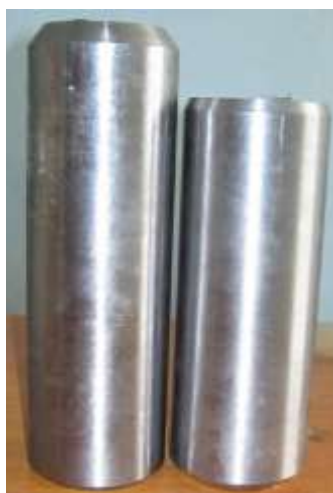
Рисунок 6.3 - Вихідні заготовки \varnothing 145 мм сплаву T120 для термомодеформаційної обробки
