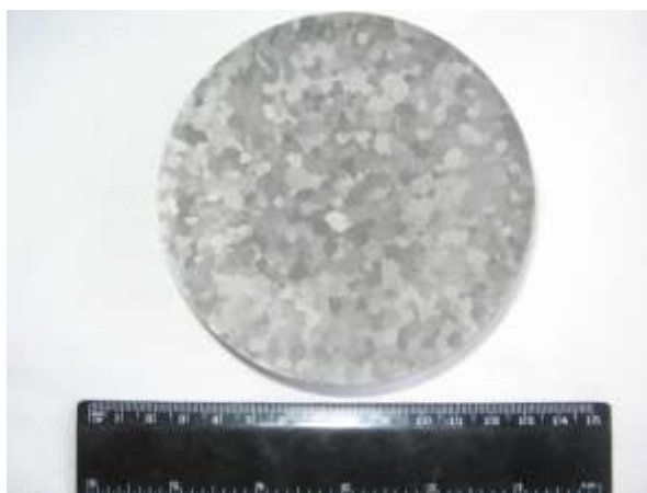
Рисунок 4.18 - Макроструктура зливка \varnothing 110 мм титанового сплаву ВТ19, отриманого методом ЕПП
