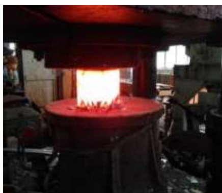
Рисунок 5.39 – Деформаційна обробка заготовок із сплавів Ti-Al-Mo-Fe та Ti-Al-Mo-Cr: а – на гідравлічному пресі; б – на реверсивному стані
