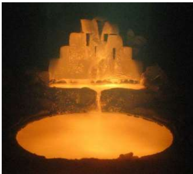
Рисунок 4.11 - Процес ЕПП зливка Ø600мм титанового сплаву VT14
