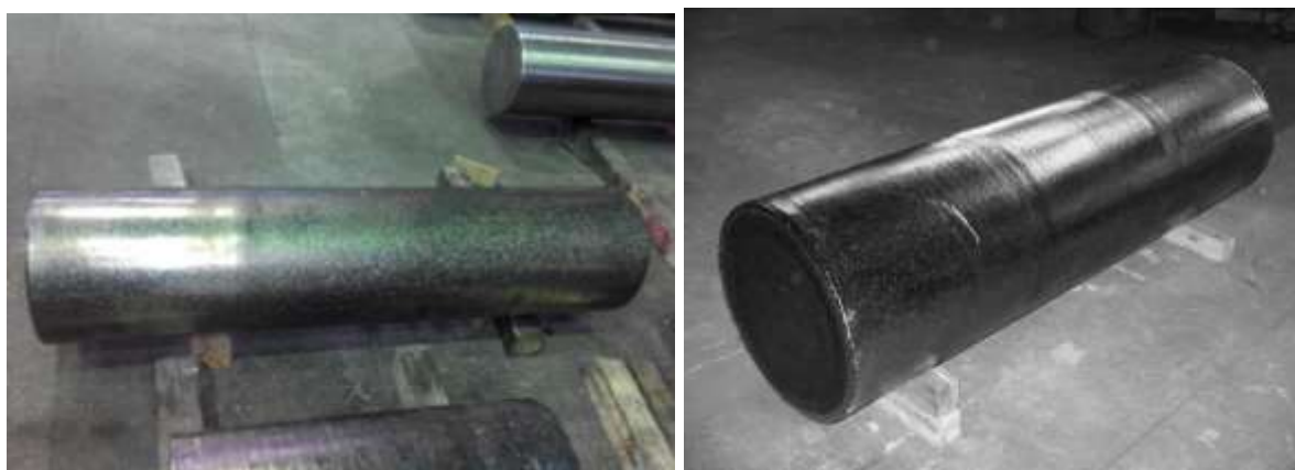
Рисунок 4.17 - Зовнішній вигляд оплавлених зливків з високоміцних титанових сплавів: а - Ø400 мм ВТ22; Ø600 мм ВТ14
