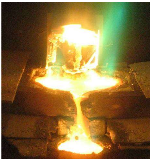
Рисунок 4.9 - Процес ЕПП зливка Ø110мм титанового сплаву ВТ19
