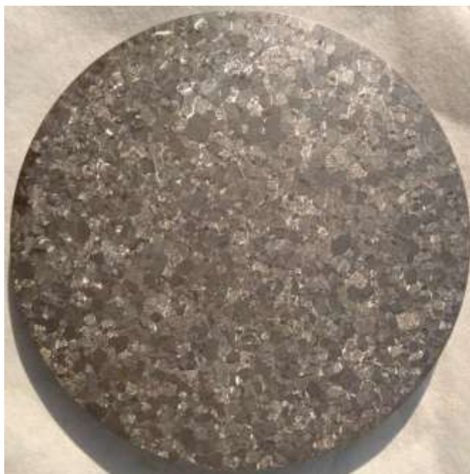
Рисунок 5.4 – Макроструктура зливка \varnothing 110 мм сплаву титана TIMETAL LCB
