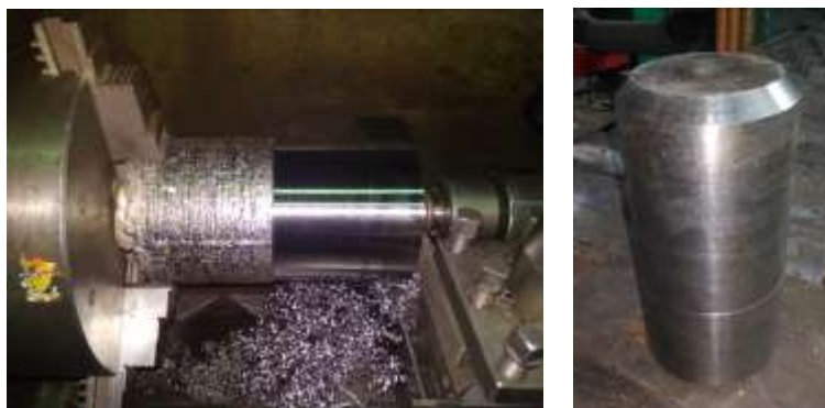
Рисунок 5.38 – Заготовка сплаву Ti-5Al-5Mo-2Fe для гарячої деформаційної обробки
