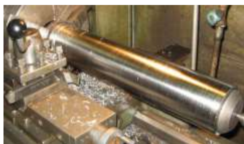
Рисунок 5.28 – Зовнішній вигляд зливку \varnothing 110 мм під час токарної обробки поверхневого шару
