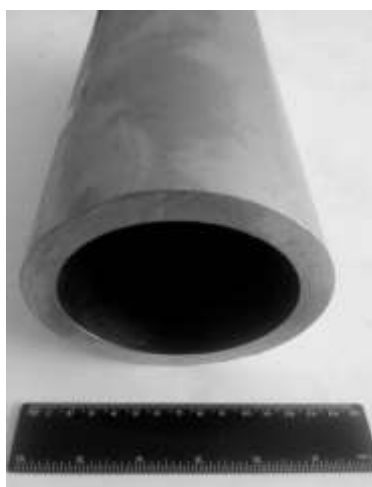
Рисунок 6.37 - Труба гарячепресована \varnothing 120 \times 15,0 \times 2500 мм після механічної обробки
