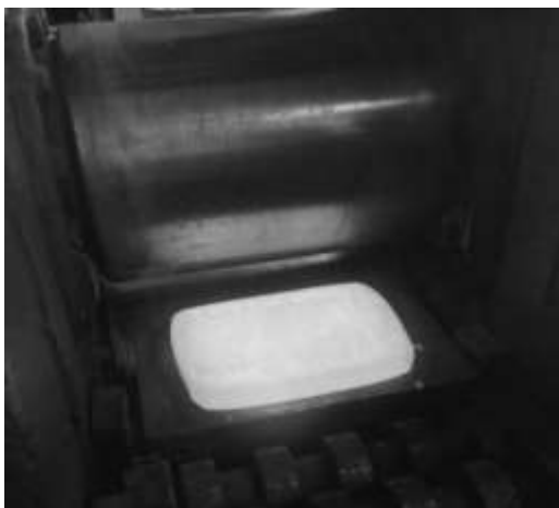
Рисунок 6.23 - Процес прокату (а) та отримані листи 350x300x6 мм (б) сплаву ВТ19
