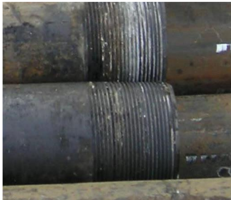
Рисунок 5.8 – Пошкодження різьб НКТ без покриття.
