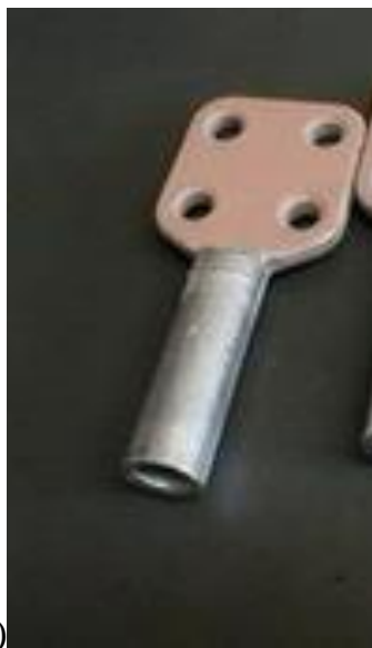
Рисунок 5.11 – Алюмінієві кабельні контакти із мідним контактними поверхням, нанесеним плазмово-дуговим напилюванням мідного дроду-аноду.
