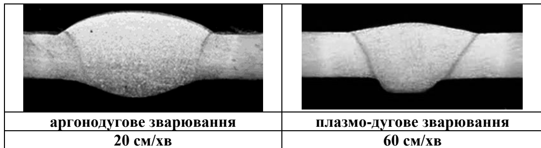
Рисунок 5.30 - Поперечні макрошліфи зварних з'єднань листів сплаву 1460 (Al-3Cu-1,8Li) товщиною 3,0 мм, отриманих різними способами зварювання неплавким електродом з використанням присадкового дроту Св1201.
