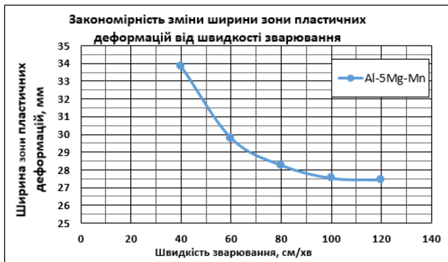
Рисунок 5.22 - Зміна ширини зони пластичних деформацій в зварних зразках товщиною 4,0 мм сплаву АМг5М (Al-5Mg-Mn) в залежності від швидкості плазмо-дугового зварювання.
