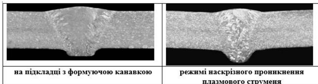
Рисунок 4.10 - Поперечні макрошліфи зварних з'єднань сплаву АМг 6 товщиною 6 мм, отриманих плазмо-дуговим зварюванням.
