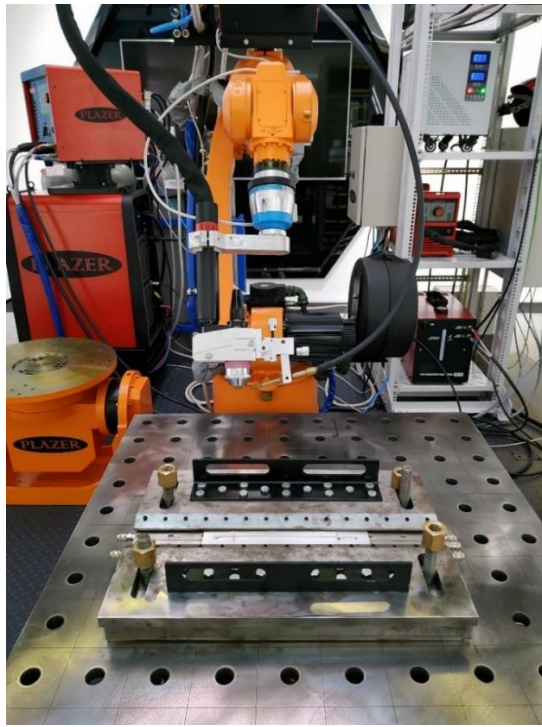
Рисунок 6.20 - Лабораторний роботизований комплекс плазмо-дугового зварювання різнополярним асиметричним струмом з подаванням присадкового дроту.
