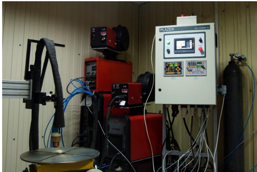
Рисунок 6.17 - Універсальний комплекс обладнання для автоматичного дугового зварювання, включаючи плазмо-дугове зварювання різнополярним асиметричним струмом та комбіноване плазмо-дугове зварювання різнополярним струмом та імпульсно-дугове зварювання плавким електродом.
