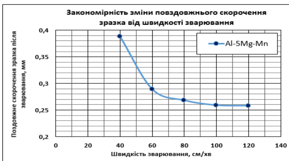
Рисунок 5.23 - Зміна повздожнього скорочення зразка товщиною 4,0 мм з сплаву АМг5М (Al-5Mg-Mn) в залежності від швидкості плазмо-дугового зварювання.
