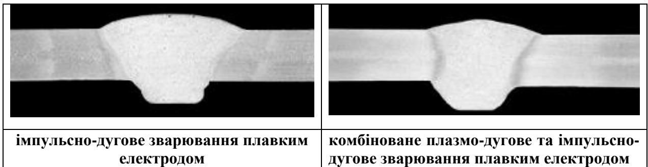
Рисунок 6.16 - Поперечні шліфи зварних з'єднань листів товщиною 5 мм із сплаву АМг6, виконаних зі швидкістю 60 см/хв (36 м/год) різними способами дугового зварювання.
