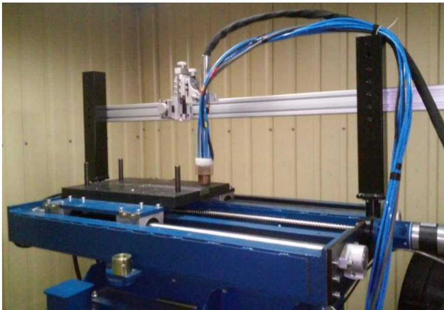
Рисунок. 2.4 - Універсальний складально-зварювальний стіл для автоматичного дугового зварювання у нижньому та вертикальному положеннях.
