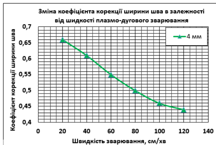
Рисунок 4.26 - Корируючий коефіцієнт між максимально допустимою шириною шва згідно стандарту та реальним значенням ширини шва при плазмо-дуговому
