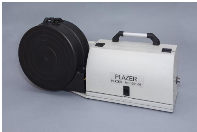
Рисунок 2.8 - Механізм подавання присадкового дроту для автоматичного плазмо-дугового зварювання різнополярним струмом алюмінієвих сплавів.
