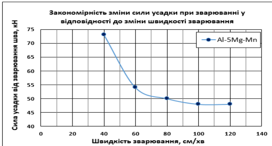
Рисунок 5.24 - Зміна сили усадки шва зразка товщиною 4,0 мм з сплаву АМг5М (Al-5Mg-Mn) в залежності від швидкості плазмо-дугового зварювання.
