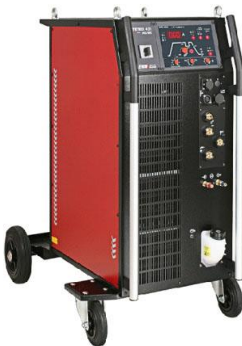
Рисунок 2.1 - Модифіковане зварювальне джерело живлення Tetrrix 421 AC/DC для аргонодугового зварювання, модифіковане для роботи у складі установки для плазмо-дугового зварювання різнополярним асиметричним струмом.
