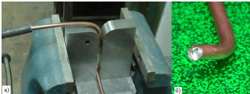
Рис. 17. Випробування на міцність зчеплення алюмінію і міді (а) та результат випробування (б)
