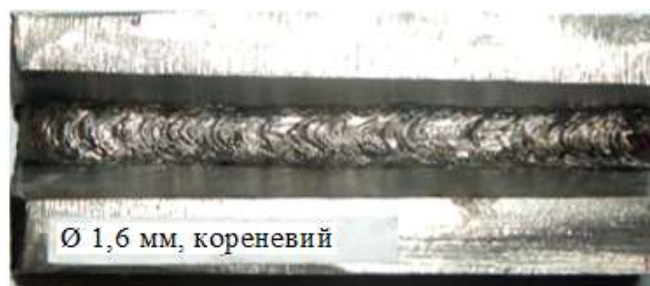
Рис. 9 – Зовнішній вигляд зразків при мокрому підводному зварюванні дослідним самозахисним порошковим дротом.
