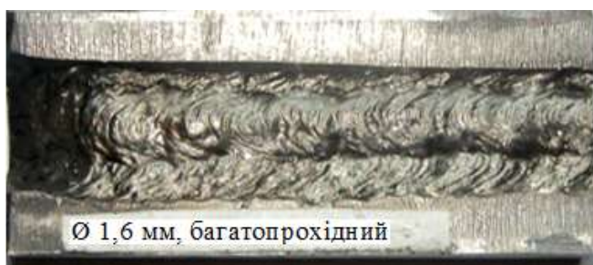
Рис. 9 – Зовнішній вигляд зразків при мокрому підводному зварюванні дослідним самозахисним порошковим дротом.
