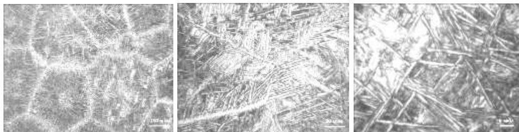
Рисунок 18 – Мікроструктура катаних пластин з титанового сплаву T120
