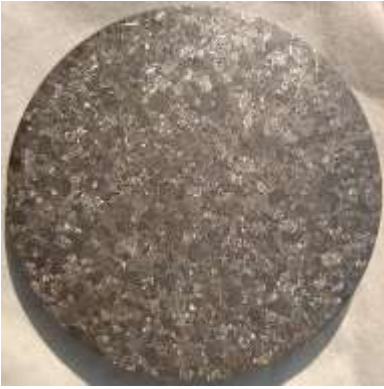
Рисунок 15 – Макроструктура зливка Ø110 мм сплаву титана TIMETAL LCB
