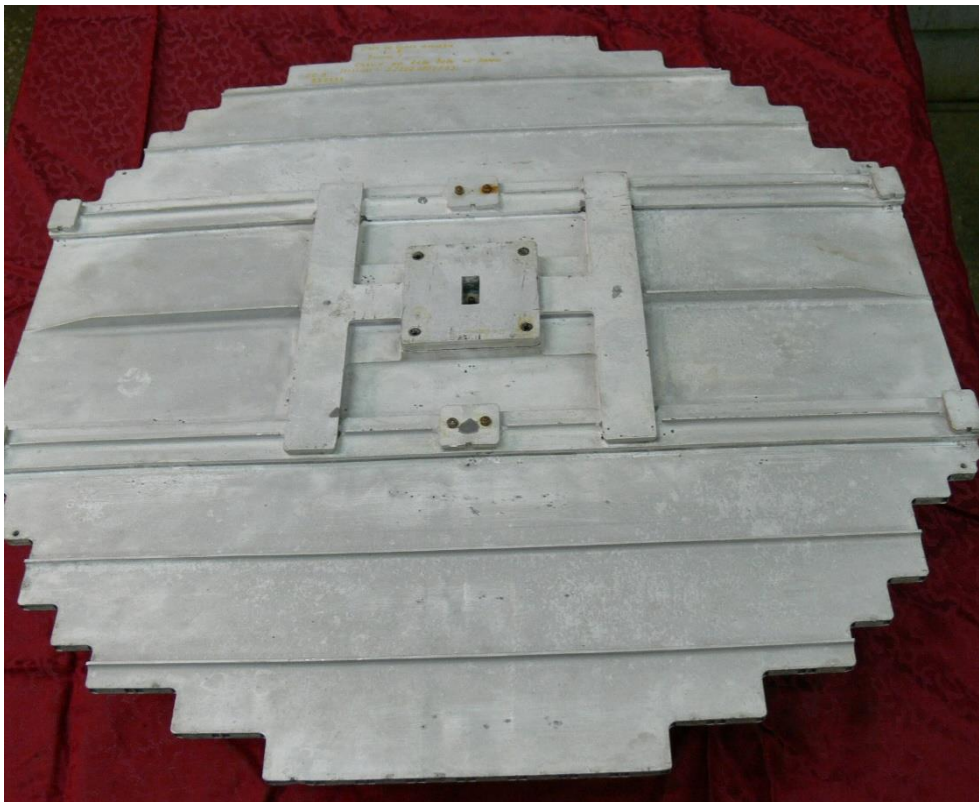
Рисунок 5.2 – Зовнішній вид паяної антени. а) вид решітки, б) вид зворотної сторони.
