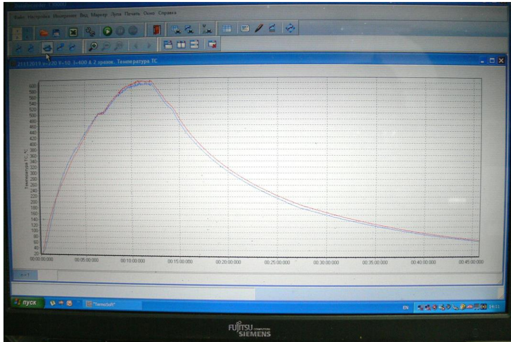
Рисунок 4.23 – Зображення реального термічного циклу паяння зразків з монітору ПК ( T_p = 605 \dots 607 \text{ } ^\circ\text{C} , час витримки 2 хв.)
