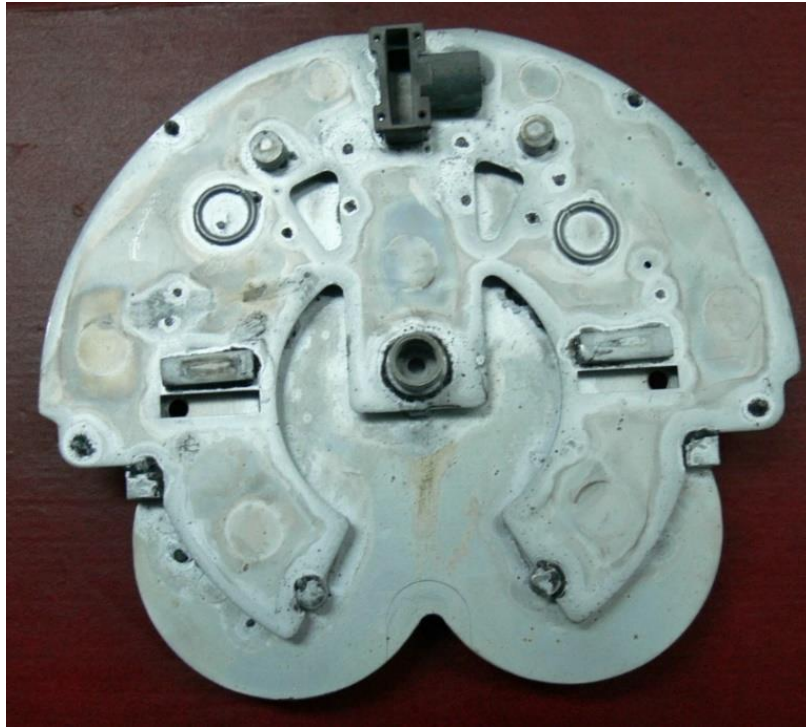
Рисунок 5.20 – Зовнішній вигляд паяного в аргоні хвильоводу після: паяння (а) без кріплення деталей на кришці зварюванням, показане заниження для литого хвильоводу
