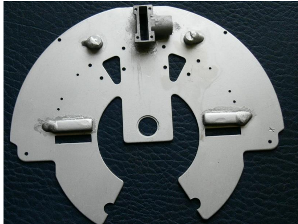
Рисунок 5.17 – Зовнішній вигляд алюмінієвої кришки після паяння окремих елементів
