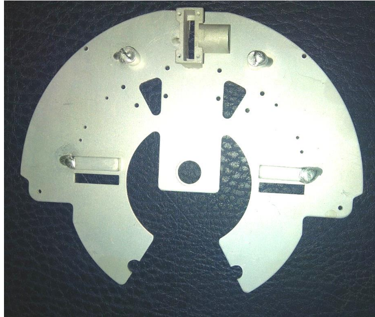
Рисунок 5.15 – Зовнішній вигляд алюмінієвої кришки хвильоводу після хімічного очищення з закріпленими зварюванням деталями
