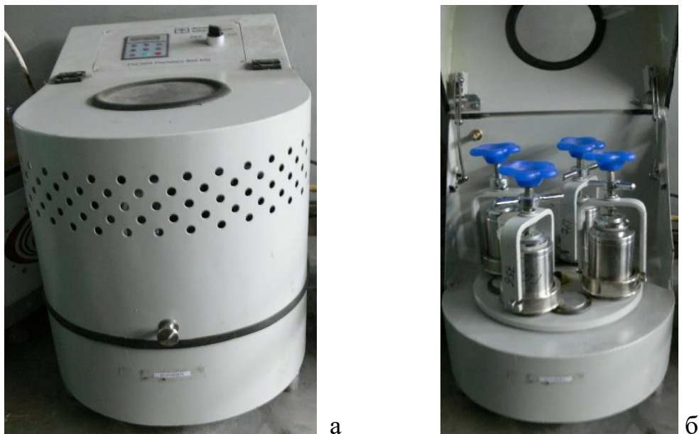
Рисунок 2.4 – Зовнішній вигляд планетарного млина PQ-N04 Planetary Ball Mill (а) і контейнери з кульками з корозійностійкої сталі (б)
