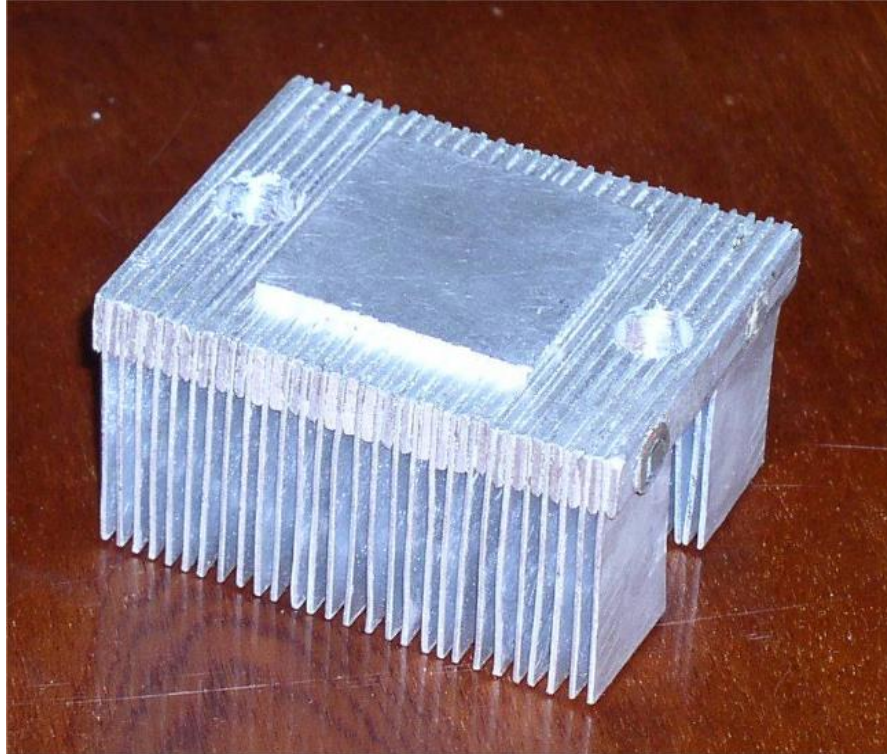
Рисунок 5.10 – Зовнішній вигляд паяного алюмінієвого пластинчастого радіатора
