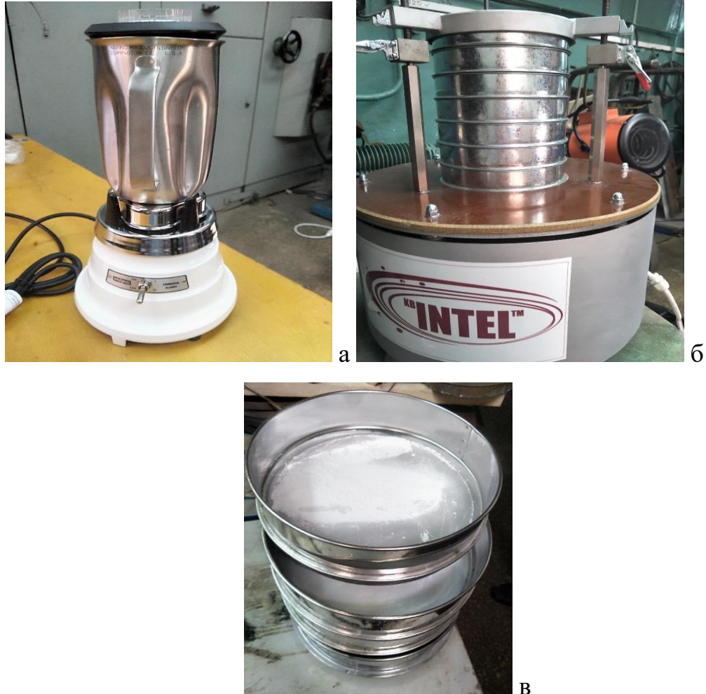
Рисунок 2.2 – Подрібнювач флюсу (а), установка для просіювання флюсу (б), сита з певною фракцією просіяного флюсу (в)
