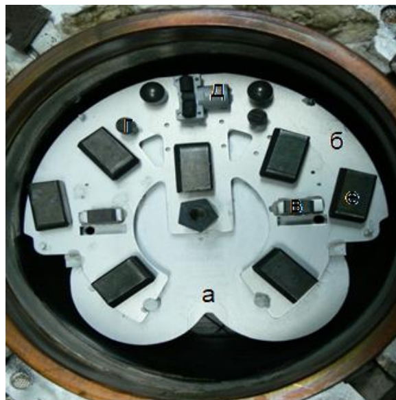
Рисунок 5.18 – Зовнішній вигляд хвильоводу (складена одиниця): основа (а), кришка (б), бобишка прямокутна (в), бобишка-циліндр (г), хвильовод литий (д), пластини сплав ВК6 (е)
