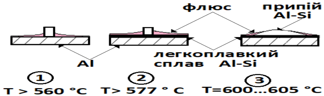
Рисунок 4.9 – Схема розтікання припою на поверхні алюмінію
