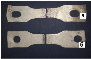
Рисунок 16 – Зовнішній вигляд зразків паяних реактивним флюсом KF-AlF_3-(K_2SiF_6 + AlF_3 + KZnF_3) без присаджування припою після випробувань: алюміній АД1+АД1 (а), сплав АМц+АМц (б)
