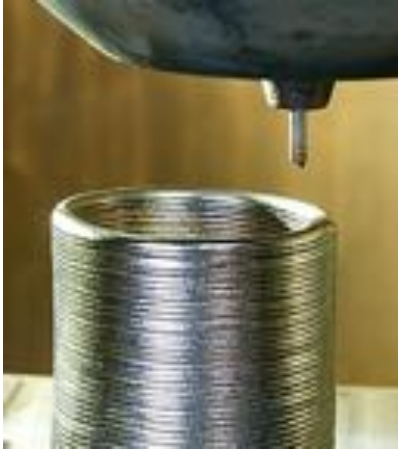
Рис. 24. Зовнішній вигляд типової посудини тиску в процесі виготовлення за допомогою технології багат шарового наплавлення xBeam 3D Metal Printer
